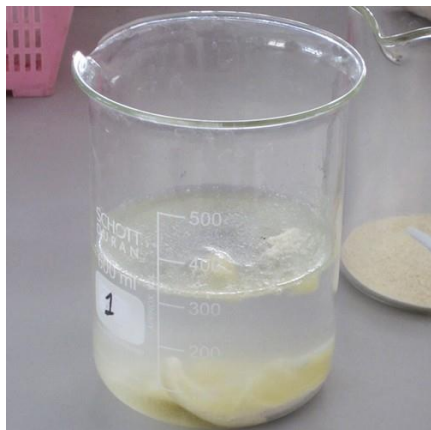
รูปที่ 6 การผสมเซลลูโลสกับสารเติมแต่งเพื่อเตรียมพลาสติกชีวภาพจากเซลลูโลส
