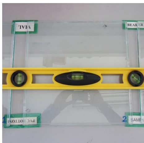
รูปที่ 7 การเตรียมแผ่นฟิล์มคาร์บอกซีเมทิลเซลลูโลส : CMC (พลาสติกชีวภาพ) บนแผ่นกระจก
