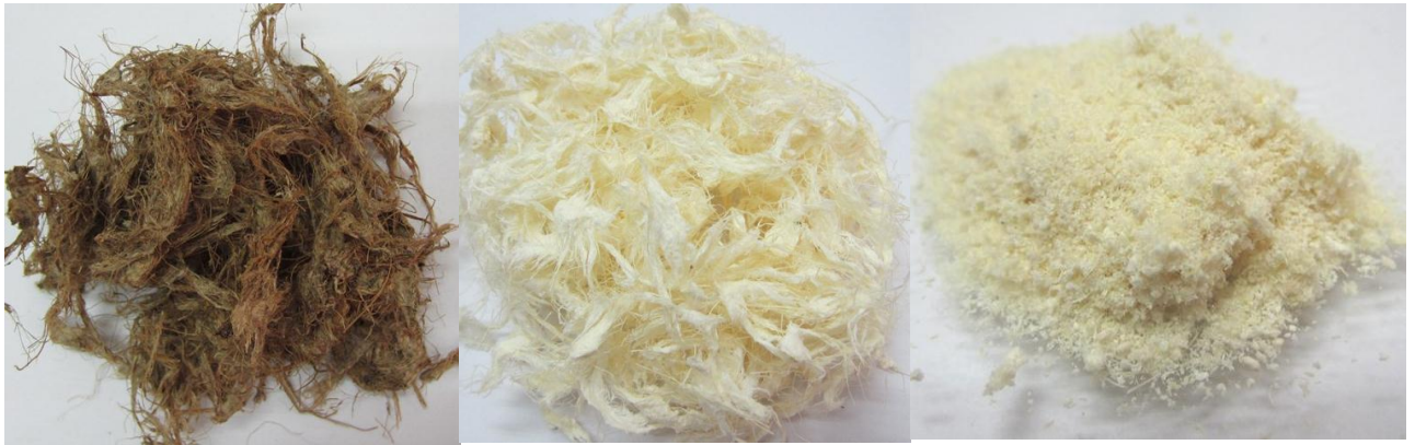
(1a) เซลลูโลสจากต้นกล้วยก่อนฟอก (1b) เซลลูโลสจากต้นกล้วยหลังฟอก คาร์บอกซีเมทิลเซลลูโลส (CMC) จากต้นกล้วย ภาพที่ 6.1 ภาพที่ 6.2
