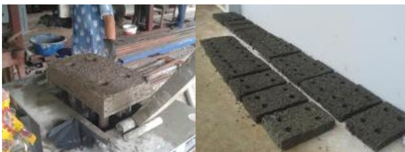
รูปที่ 11คายชิ้นงานออกด้านบนของเครื่อง รูปที่ 12 ก้อนวัสดุปลูกกล้วยไม้ที่อัดแล้ว
