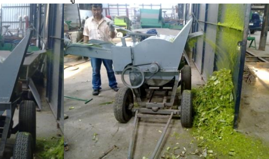
รูปที่ 10. หั่นย่อยสับปรด, ทะลายปาล์ม, ทางปาล์มและทางสละ
