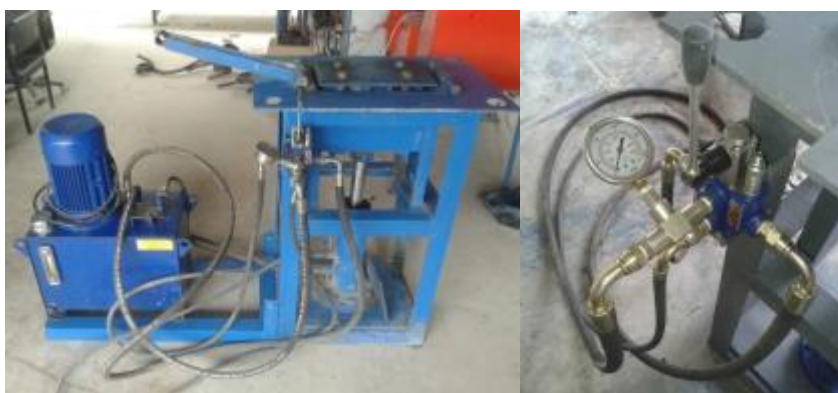
รูปที่ 4 เครื่องต้นแบบผลิตวัสดุปลุกกล้วยไม้รูปที่ 5 วาล์วคั่นโยกควบคุมกระบอกไฮดรอลิกขึ้นลง
