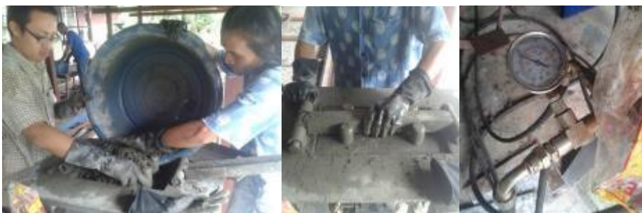
รูปที่ 8 นำส่วนผสมใส่ลงในเครื่องอัดรูปที่ 9 ใส่สลักล็อกแผ่นอัดรูปที่ 10 อัดที่แรงดัน 100 บาร์
