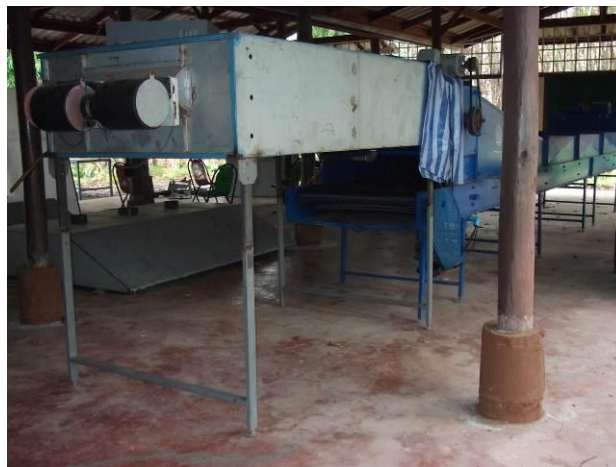
รูปที่ 27. เครื่องลดความชื้นกล้วยไม้แบบอุโมงค์ลมที่มีระบบลดความชื้นแบบปั๊มความร้อนต้นแบบ
