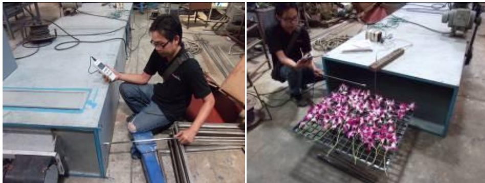
รูปที่ 19. วัดอุณหภูมิและความเร็วลมของอากาศ รูปที่ 20. ทดสอบระบบลดความชื้นช่อดอกกล้วยไม้ต้นแบบ
