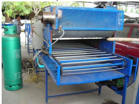
รูปที่ 3. ชุดให้ความร้อนแบบหัวพันแก๊สหุงต้ม
