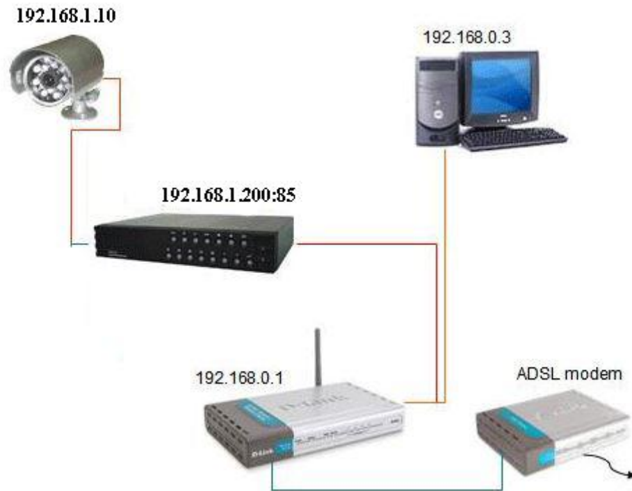
ภาพที่ 10 การเชื่อมต่อสัญญาณภาพอุปกรณ์ตรวจจับคดีที่ถูกล้วงไม้ด้วยการประมวลผลภาพแบบกล้องดิจิทัล IP Camera
