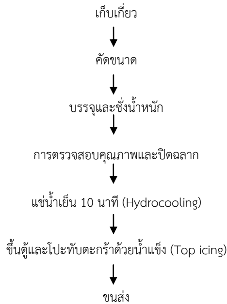
ภาพที่ 1 การลดอุณหภูมิด้วยน้ำเย็น (Hydrocooling)
