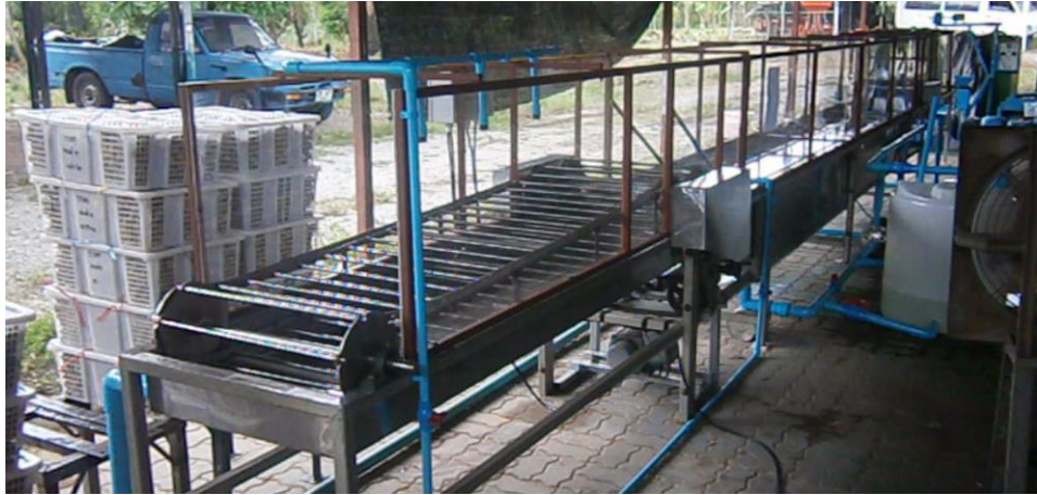
ภาพที่ 1 ต้นแบบเครื่องจุ่มสาร HCl สำหรับผลลำไยสด (สนองและคณะ ,2556)
