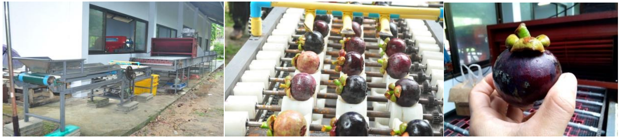
รูปที่ 39 ทดสอบเป้าน้ำใต้ก๊ลิบเลี้ยงมังคุด
