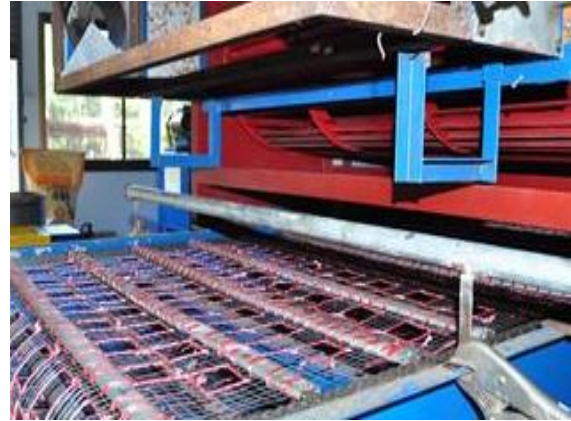
รูปที่ 24 ติดตั้งชุดเป่าน้ำด้านบนชุดลำเลียง
