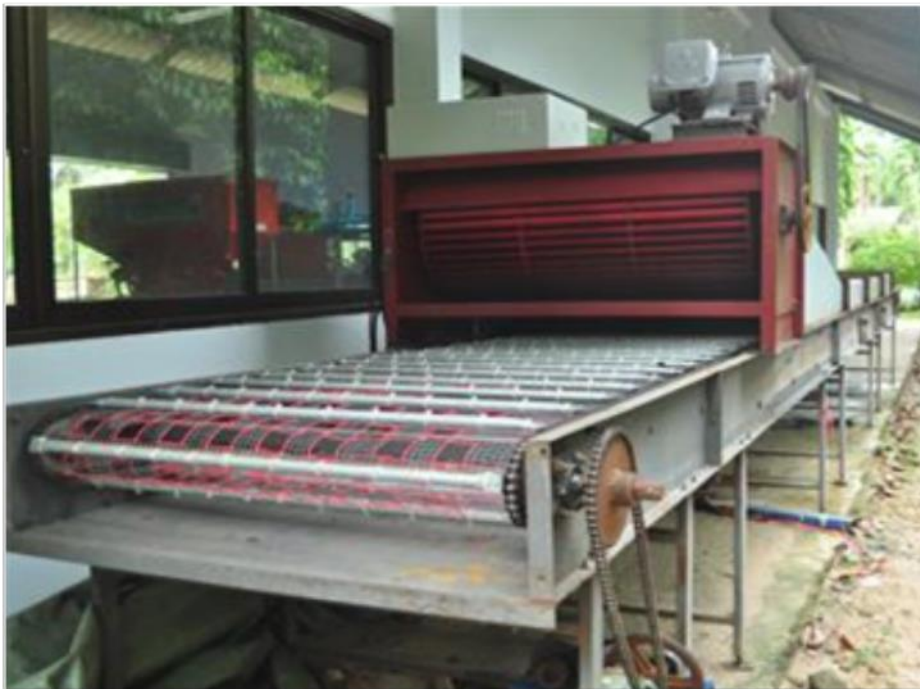
รูปที่ 29 เครื่องต้นแบบเป่าแห้งมุ้งคุดสดแบบอุโมงค์ลมเสร็จแล้ว 90 เปอร์เซ็นต์
