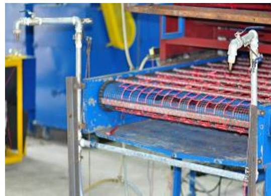
รูปที่ 26 ติดตั้งชุดหัวลมเป่าน้ำด้านบนหน้าเครื่อง
