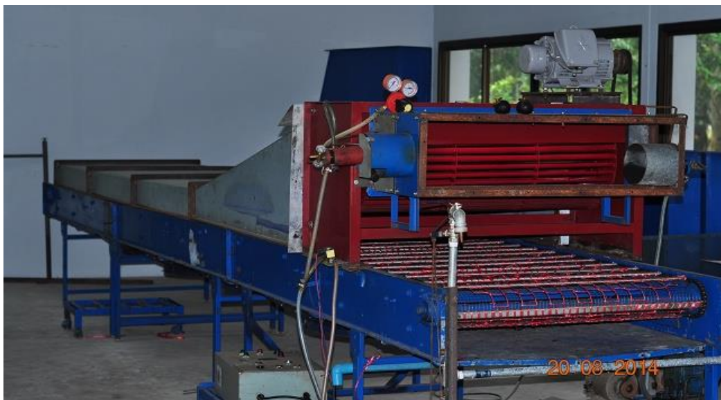
รูปที่ 27 ต้นแบบเครื่องเป่าแห้งมังคุดสดหลังการปรับปรุง
