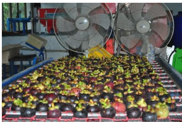
รูปที่ 36 ทดสอบเวลาในการเป่าแห้งมังคุดสดโดยการใช้พัดลม
