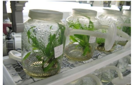
ภาพที่ 6.4 ระบบ TIB ที่ประกอบด้วยขวดแก้วขนาดความจุ 500 มิลลิลิตร
