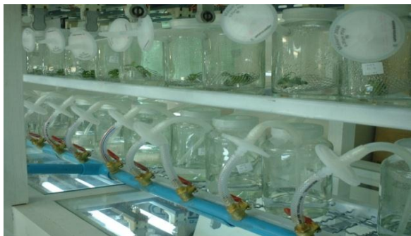
ภาพที่ 6.4 ระบบ TIB ที่ประกอบด้วยขวดแก้วขนาดความจุ 500 มิลลิลิตร
