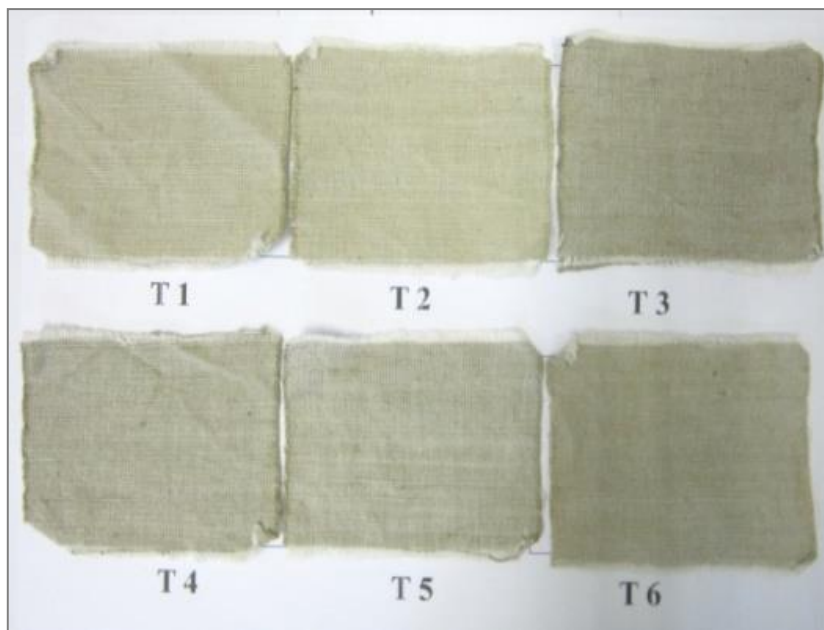
ภาพที่ 5 ผลของสารละลายต่างต่อการเปลี่ยนแปลงสีเส้นด้าย(บน) และผืนผ้า (ล่าง) (T1= น้ำที่อุณหภูมิห้อง 25°C(ควบคุม) T2=น้ำที่ 100°C T3=0.25% \text{Ca}(\text{OH})_2 ที่ 100°C T4= 5%น้ำปูนใสที่ 100°C T5 =5% น้ำซี้เถ้าที่ 100°C และT6 = 20% น้ำซี้เถ้าที่ 100°C)
