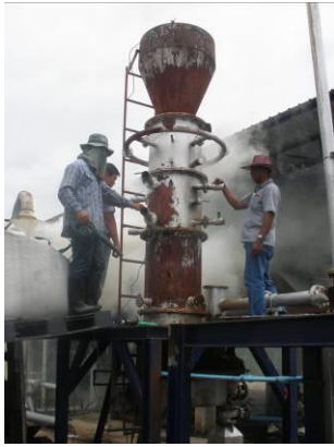
ภาพที่ 3 ทดสอบเตา Downdraft Gasifier และทดสอบจุดไฟจากแก๊สที่ได้
