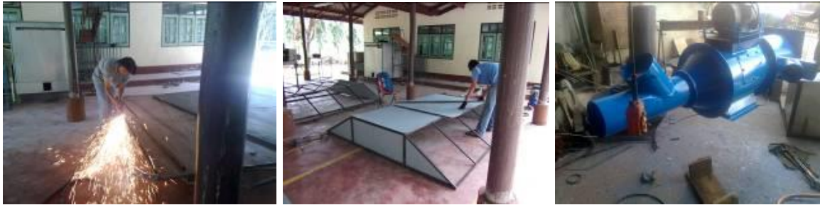
ภาพที่ ๒ การประกอบโครงห้องอบทะเลลายปาล์ม การติดตั้งผนังห้องอบและชุดพัดลม
