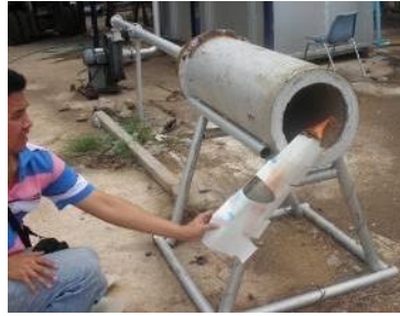
ภาพที่ 3 ทดสอบเตา Downdraft Gasifier และทดสอบจุดไฟจากแก๊สที่ได้
