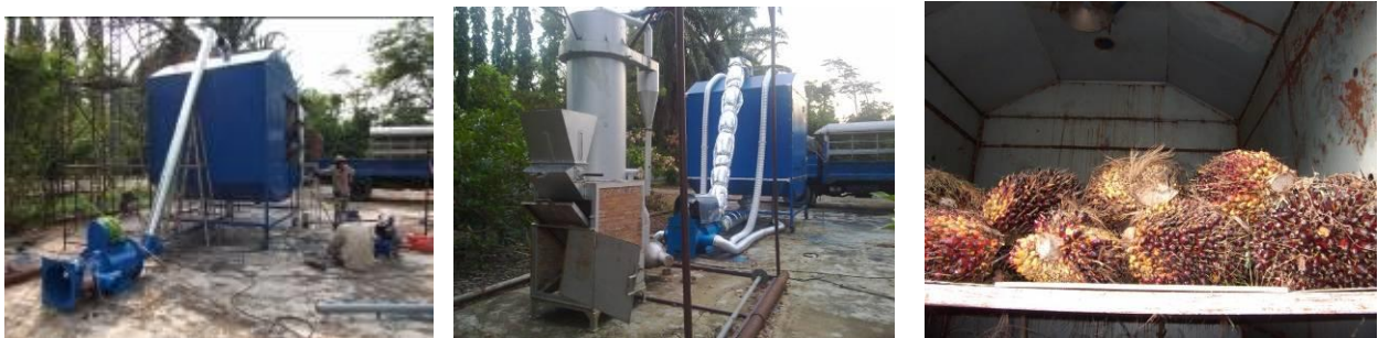
ภาพที่ ๓ ประกอบชุดให้ความร้อนทะเลลายปาล์มน้ำมันระดับเชิงพาณิชย์ต้นแบบและสภาพภายในห้องให้ความร้อน
