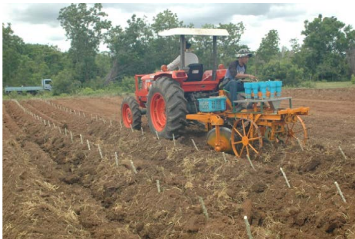
รูปที่ 3 การทดสอบเครื่องปลูกมันสำปะหลังในสภาพดินร่วน
