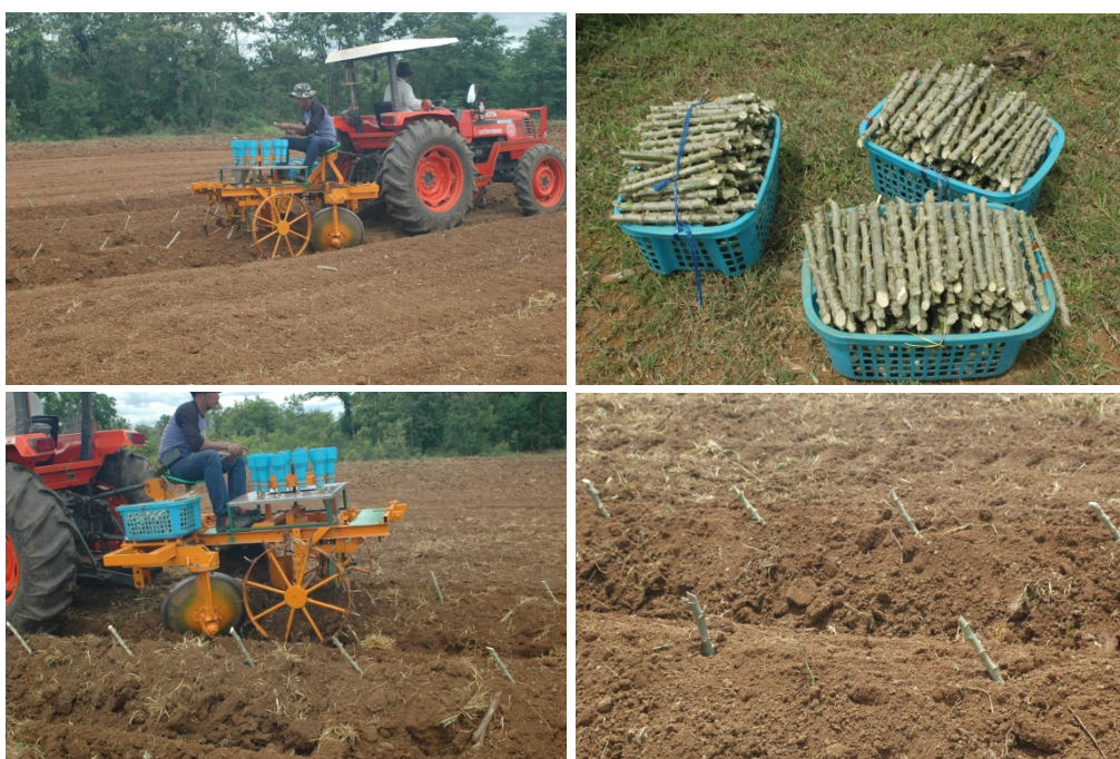
รูปที่ 14 การทดสอบเครื่องปลูกมันสำปะหลังในดินร่วน
