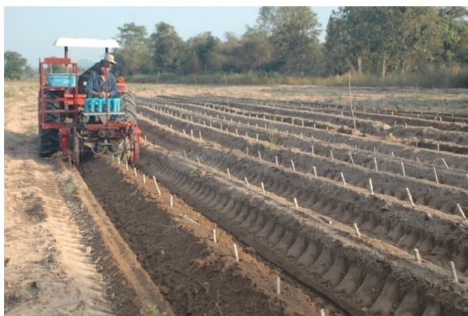
รูปที่ 2 การทดสอบเครื่องปลูกมันสำปะหลังต้นแบบของสถาบันวิจัยเกษตรวิศวกรรม
