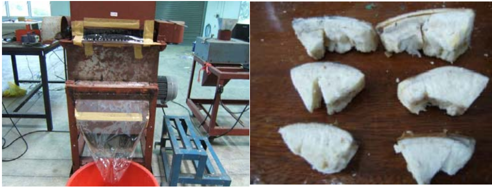
รูปที่ 1.5 เครื่องสับมันเส้นที่มหาวิทยาลัยเกษตรศาสตร์พัฒนาขึ้นและลักษณะชิ้นมันที่ผ่านการสับ
