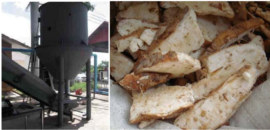
รูปที่ 1.3 เครื่องสับมันสำปะหลังแนวตั้งและลักษณะชิ้นมันที่ผ่านการสับด้วยเครื่อง ที่มา: ศูนย์นวัตกรรมเทคโนโลยีหลังการเก็บเกี่ยว.2551
