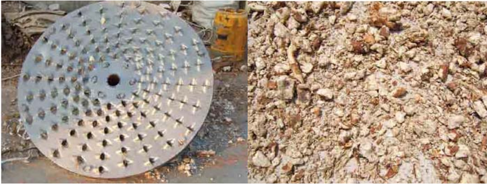
รูปที่ 1.2 ลักษณะจานหมุนและชิ้นมันสำปะหลังที่ผ่านการสับ
