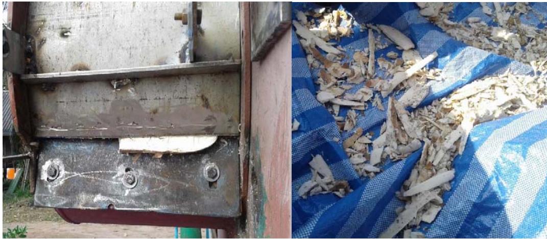
รูปที่ 1.10 ไบมีดที่ทำการปรับปรุงและทดสอบสับมันเส้นเป็นแบบแผ่น
