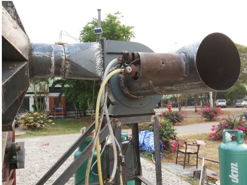
รูปที่ 2.14 พัดลมแบบแรงเหวี่ยงหนีศูนย์กลาง แก๊สหุงต้ม(LPG) สำหรับลมร้อนในการอบแห้ง
