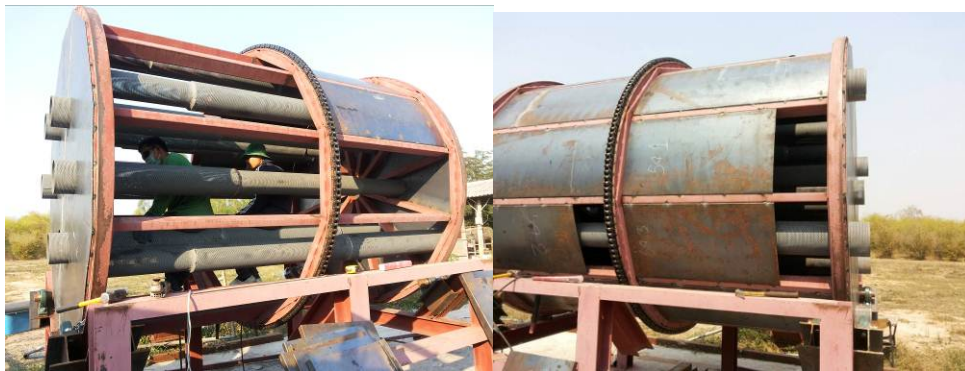
รูปที่ 2.12 การติดตั้งท่อกระจายลมร้อนภายในถังอบ
