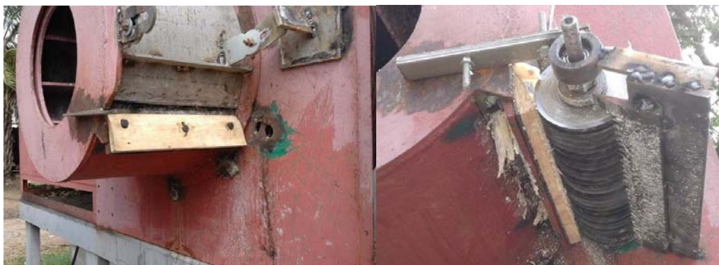
รูปที่ 1.12 ชุดไบมีด เขียงและไบกันชื้นมันติดไบมีด
