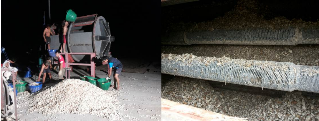
รูปที่ 2.16 การทดสอบการอบแห้งมันเส้นด้วยเครื่องอบแบบโรตารี
