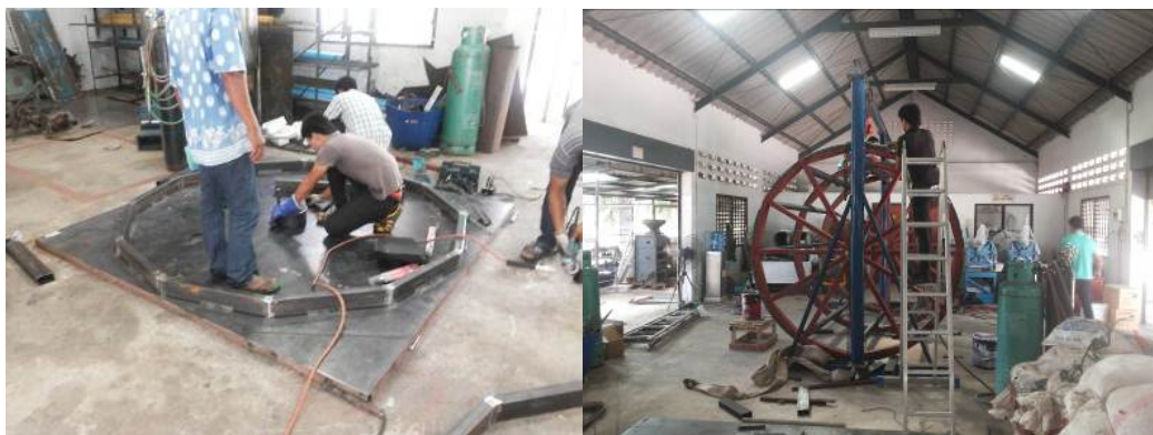
รูปที่ 2.10 การสร้างถังอบแห้งมันเส้นขนาดความจุ 5 ตันมันเส้นสด
