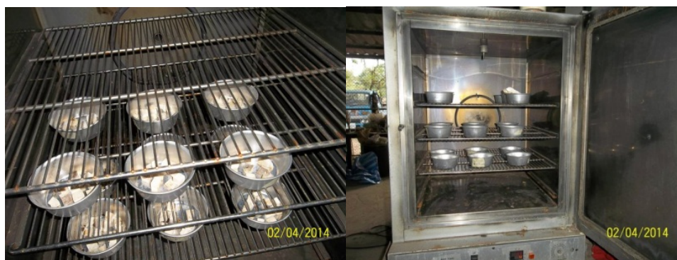
รูปที่ 2.4 การหาความชื้นด้วยตู้อบ
