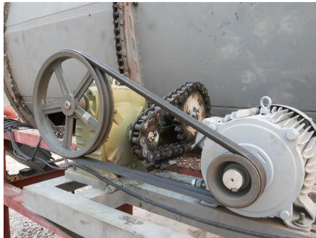
รูปที่ 2.13 การหมุนถังอบด้วยเฟืองโซ่ เบอร์ 120 มอเตอร์ 7.5 แรงม้า
