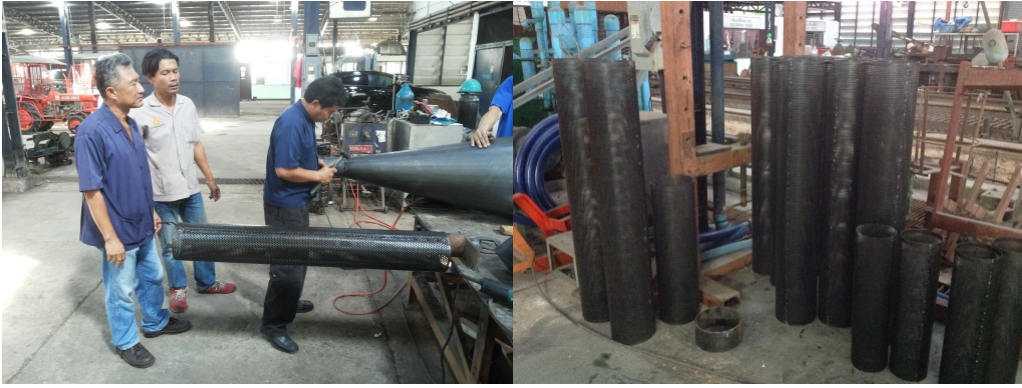
รูปที่ 2.11 การม้วนและเชื่อมต่อท่อลมถังอบแห้งมันเส้น
