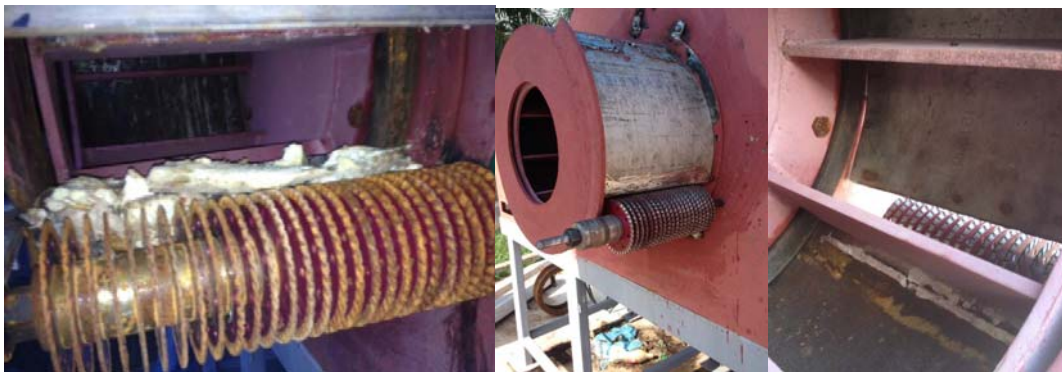
รูปที่ 1.11 ชุดไบมีดสับมันสำปะหลังที่ทำให้เป็นเส้น
