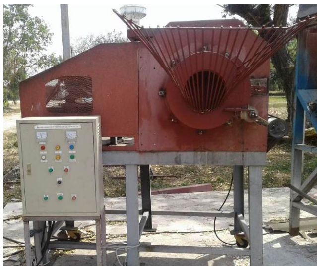
รูปที่ 1.16 เครื่องต้นแบบสับมันสำปะหลังให้เป็นแบบเต๋า
