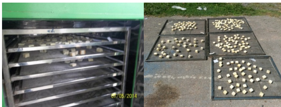
รูปที่ 2.5 การอบแห้งมันเส้นด้วยเครื่องอบลมร้อนแบบถาดที่ อุณหภูมิ 90 และ 105 องศาเซลเซียส เพื่อหาการยุบตัว
