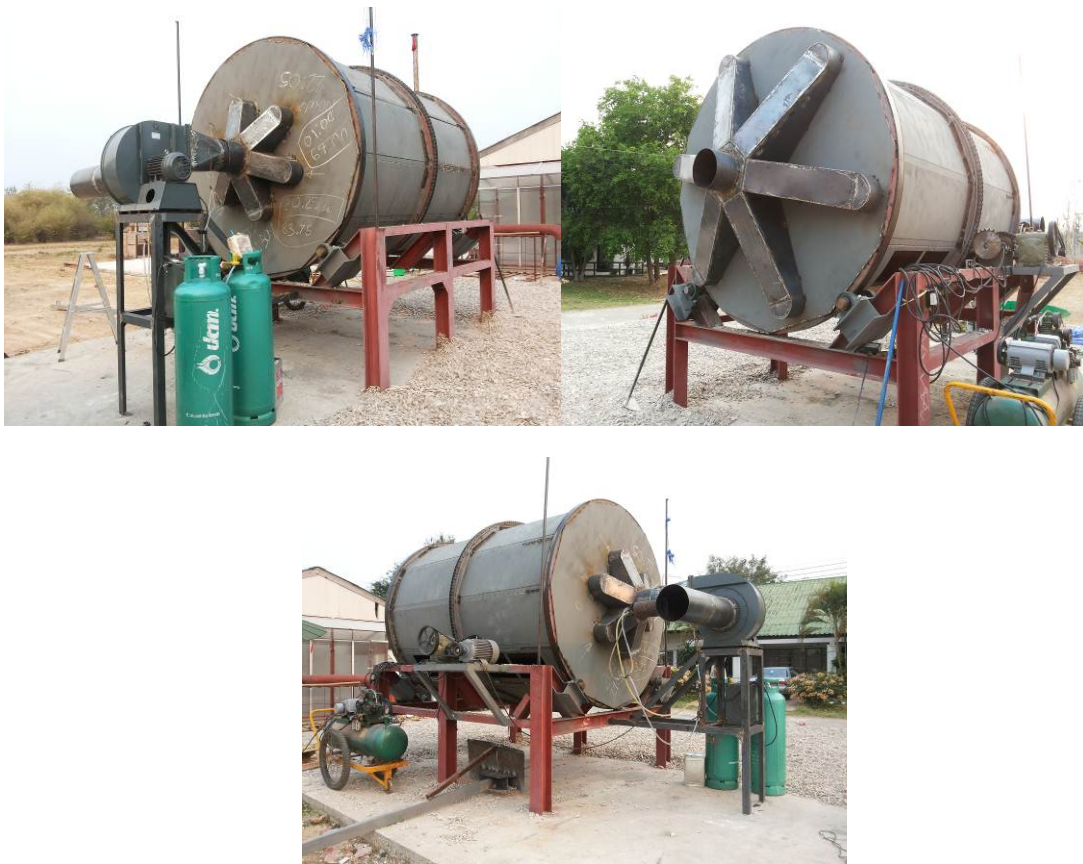
รูปที่ 2.15 เครื่องอบแห้งมันเส้นแบบโรตารีที่สร้างเสร็จแล้ว
