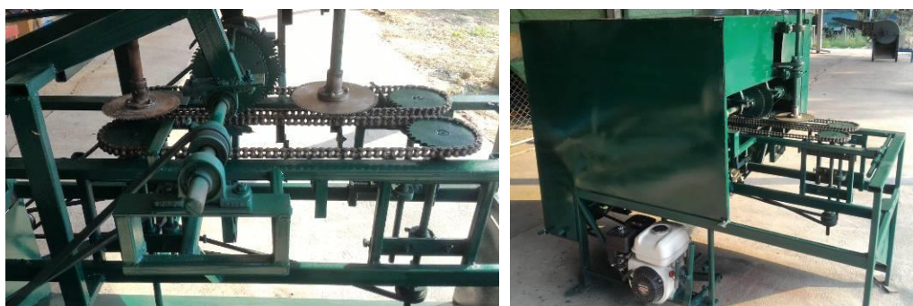
รูปที่ 39 เครื่องต้นแบบที่ 2 ที่เพิ่มใบเลื่อยด้านหลัง และเครื่องต้นแบบที่ประกอบโครงป้องกัน
