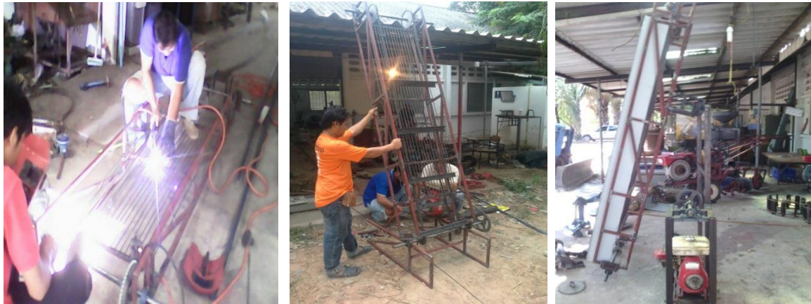
รูปที่ 8 การสร้างเครื่องมือขนย้ายและลำเลียงหัวมันสำปะหลัง
