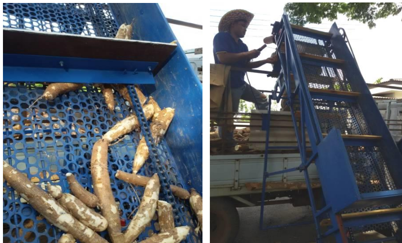
รูปที่ 12 ปัญหาของการลำเลียงหัวมันสำปะหลังและการแก้ไขต้นแบบในภาคสนามขณะทดสอบ
