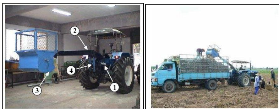
รูปที่ 5 อุปกรณ์ช่วยขนย้ายหัวมันสำปะหลังขึ้นรถบรรทุก
