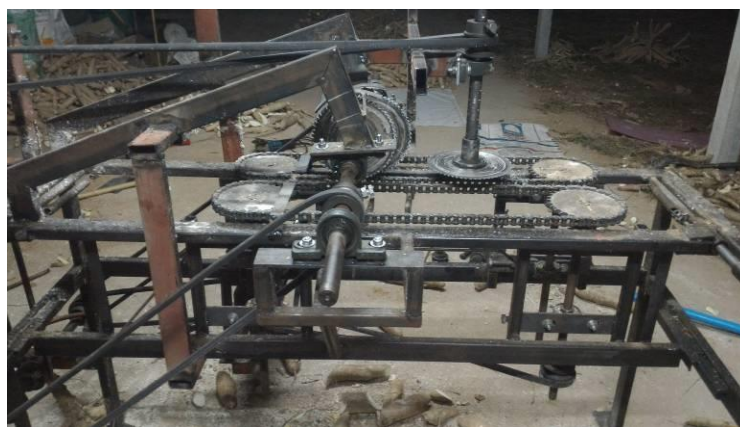
รูปที่ 37 เครื่องต้นแบบที่ย้ายใบเลื่อยหลังมาอยู่ด้านหน้า ใบเลื่อยตัดข้างหมุนทิศเดียวกัน
