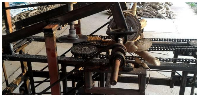
รูปที่ 36 การตัดขีดของหัวมันในใบเลื่อยด้านข้างเครื่องต้นแบบหลังจากที่ย้ายใบเลื่อยหลังให้อยู่ด้านบน
