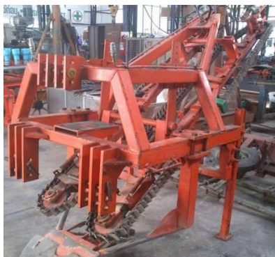
รูปที่ 1 เครื่องชุดเก็บมันสำปะหลัง กรมวิชาการเกษตร
