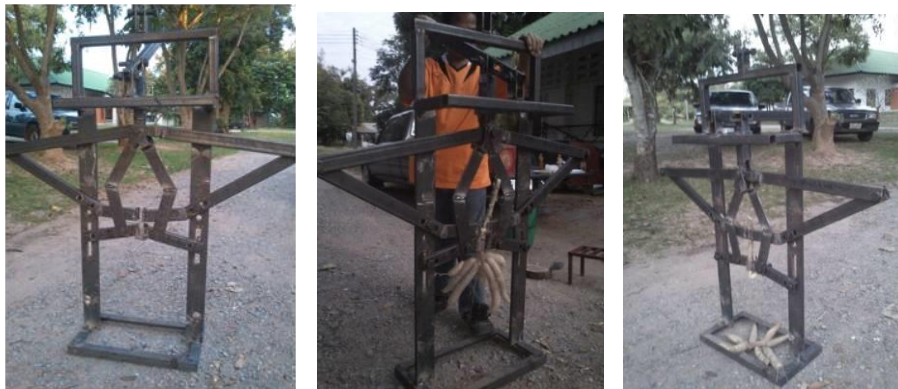
รูปที่ 22 ต้นแบบที่ 1 ที่สร้างจากกลไกแบบที่ 4 และการทดสอบการปลดหัวมันออกจากเหง้า
