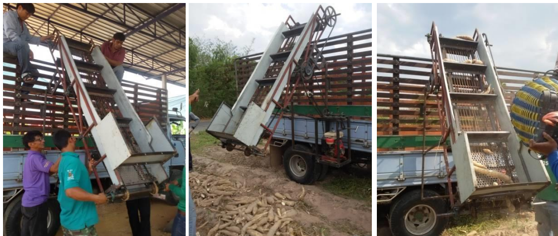
รูปที่ 9 ลักษณะการติดตั้งด้านข้างรถบรรทุกของเครื่องขนย้ายหัวมันฯ
