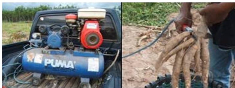
รูปที่ 2 เครื่องมือตัดหัวมันสำปะหลังออกจากเหง้าแบบใบเลื่อยชักระบบนิวเมติกส์
