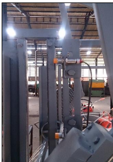
รูปที่ 14 การติดตั้ง Proximity sensor กำหนดระยะเลื่อนขึ้นลงของลูกปัด
