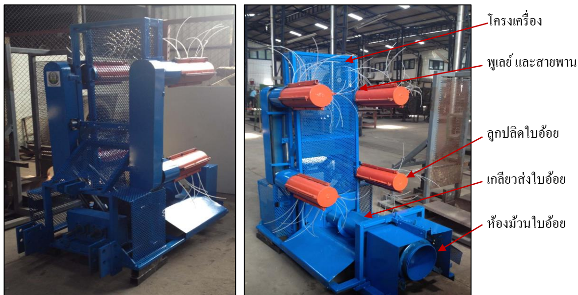
ภาพที่ 19 เครื่องต้นแบบ ด้านหน้า (ซ้าย) และด้านหลัง (ขวา)
