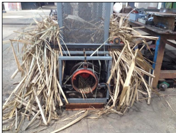
รูปที่ 14 ใบอ้อยติดขัดกับลูกปผลิต
