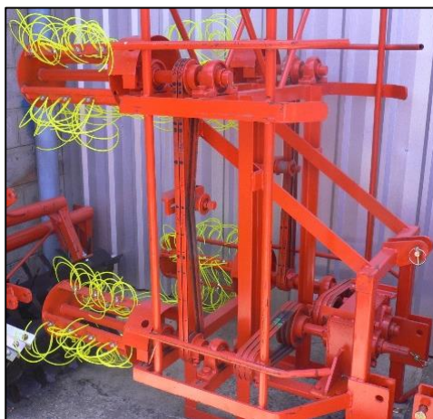
รูปที่ 3 เครื่องสางใบอ้อยที่พัฒนาโดยเอกชน
