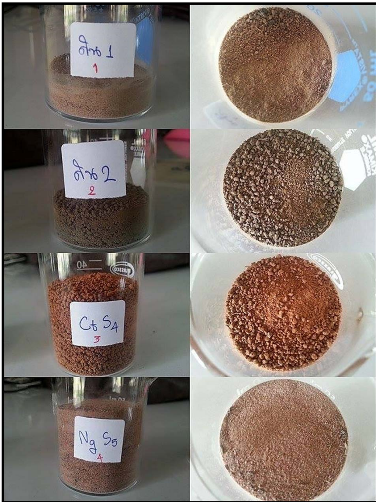
รูปที่ 21 ชนิดดินที่ทำการวิเคราะห์ในห้องปฏิบัติการและทราบค่าในการวิเคราะห์เพื่อนำมาใช้ในการวิเคราะห์ร่วมกับชุด KIT
