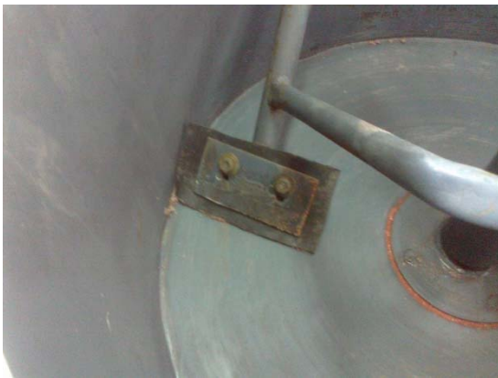
รูปที่ 10 การปรับปรุงเครื่องผสมปูนให้เป็นเครื่องผสมปุ๋ยโดยการใส่แผ่นยางที่ใบกวน
