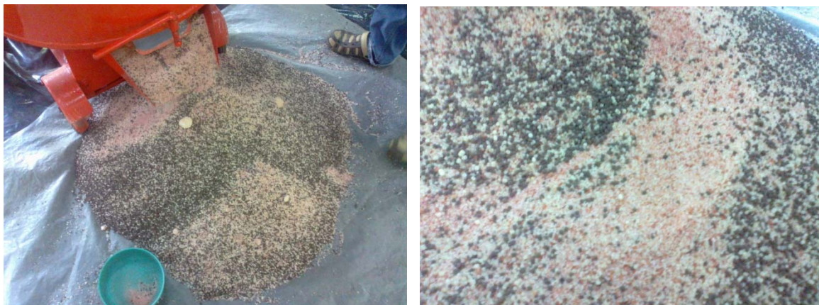
รูปที่ 8 ลักษณะการแยกตัวของปุ๋ยที่มีขนาดแตกต่างกัน
