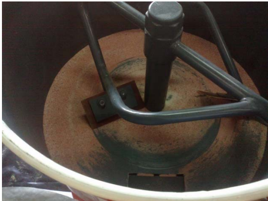
รูปที่ 10 การปรับปรุงเครื่องผสมปูนให้เป็นเครื่องผสมปุ๋ยโดยการใส่แผ่นยางที่ใบกวน
