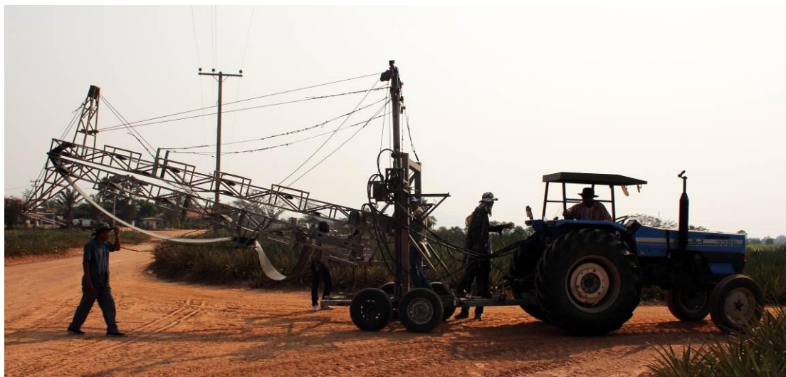
รูปที่ 10 เครื่องลำเลียงผลสับปรดขณะเดินทาง
