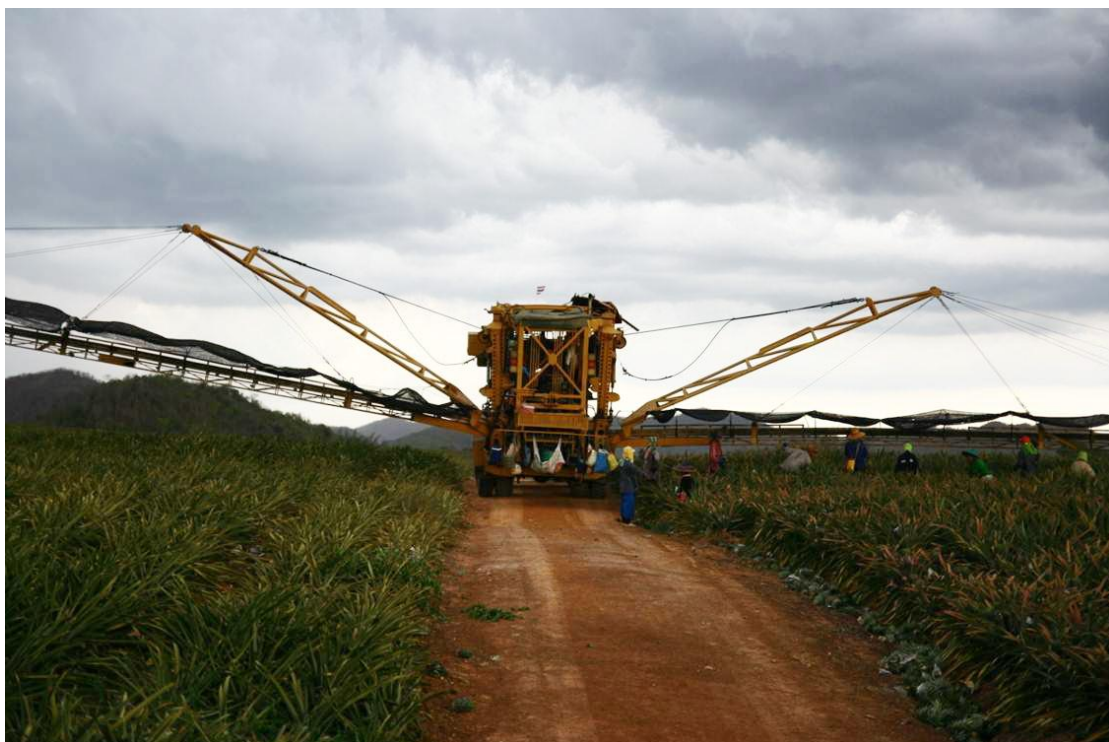
รูปที่ 4 เครื่องลำเลียงผลสับปะรดของโรงงานแปรรูปสับปะรด
