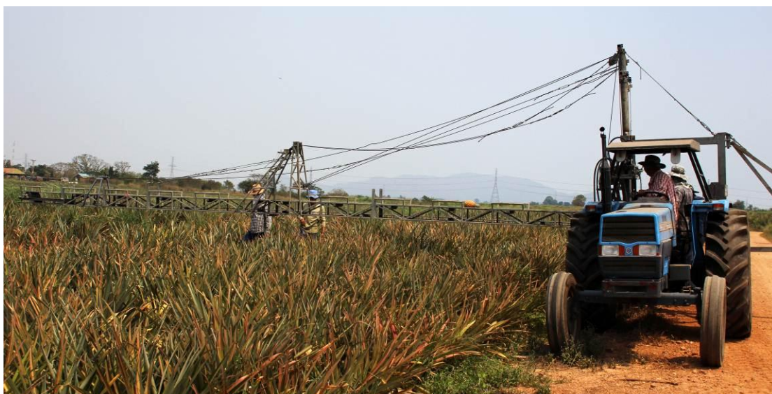
รูปที่ 11 เครื่องลำเลียงผลสับปรดขณะทำงาน
