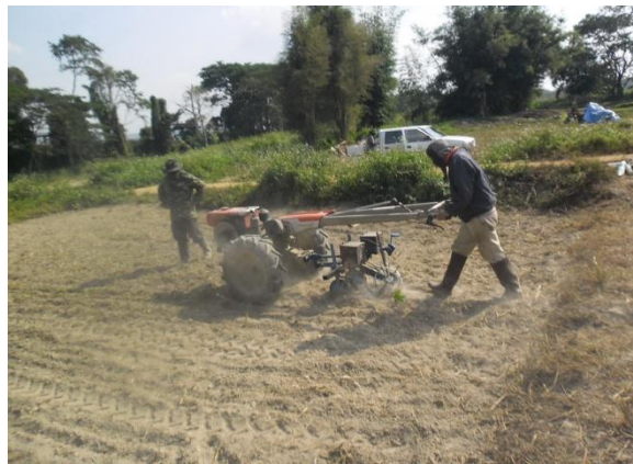
ภาพที่ 18 การทดสอบเครื่องหยอดถั่วเหลืองฝักสดในภาคสนาม
