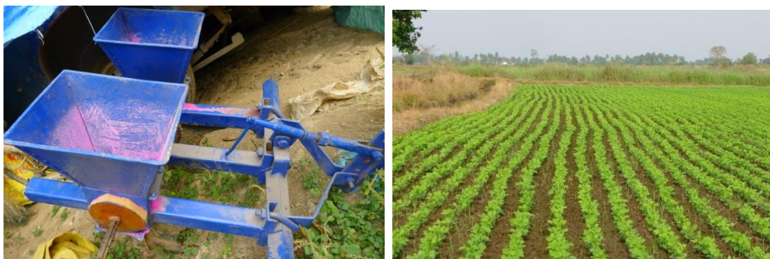
ภาพที่ 7 เครื่องหยอดถั่วเหลืองแบบตัว ที่หัวกลับ และแปลงเกษตรกรที่ใช้เครื่องหยอด การพัฒนาเครื่องต้นแบบ
