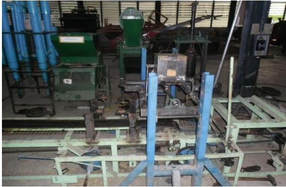
ภาพที่ 17 การทดสอบเครื่องต้นแบบตามมาตรฐานผลิตภัณฑ์อุตสาหกรรมเครื่องหยอดเมล็ดพืช (มอก.1236-2537)
