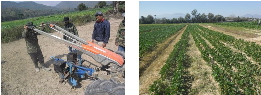
ภาพที่ 5 การทดสอบเครื่องหยอดเมล็ดพืชในแปลงเกษตรกร
