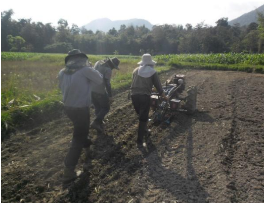
ภาพที่ 18 การทดสอบเครื่องหยอดถั่วเหลืองฝักสดในภาคสนาม
