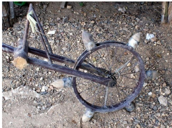
ภาพที่ 6 เครื่องเจาะหลุมเกษตรกรประดิษฐ์แบบล้อจักรยาน
