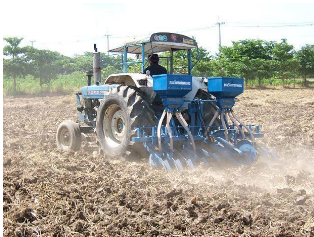
รูปที่ 3 เครื่องหยอดติดพวงรถแทรกเตอร์ขนาดใหญ่
