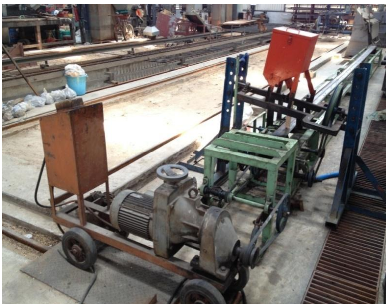
รูปที่ 21 มอเตอร์ปรับรอบได้ ที่สามารถปรับให้รอบของเครื่องหยอดสอดคล้องกับการเคลื่อนที่ของรถแทรกเตอร์ ผลการทดสอบในห้องปฏิบัติการ
