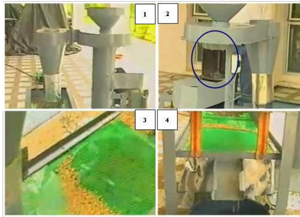
ภาพที่ 2 ภาพแสดงเครื่องกะเทาะเมล็ดัตานตะวันระดับอุตสาหกรรมขนาดเล็ก (1) แสดงส่วนบนของเครื่อง: เครื่องกะเทาะระบบแรงเหวี่ยงแบบทรงกำลัง (2) ชุดใบพืดตีเมล็ด (ในวงกลม) (3) ไซโคลนดักฝุ่น)
