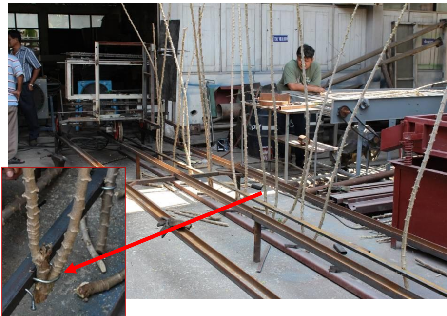
รูปที่ 7 รางวิ่งของชุดทดสอบ และการจับยึดต้นมันสำปะหลังสำหรับการทดสอบ
