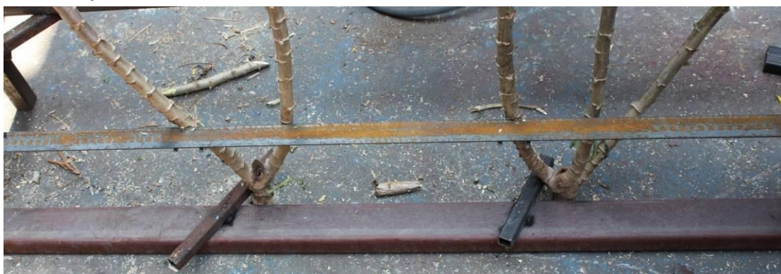
รูปที่ 7 รางวิ่งของชุดทดสอบ และการจับยึดต้นมันสำปะหลังสำหรับการทดสอบ
