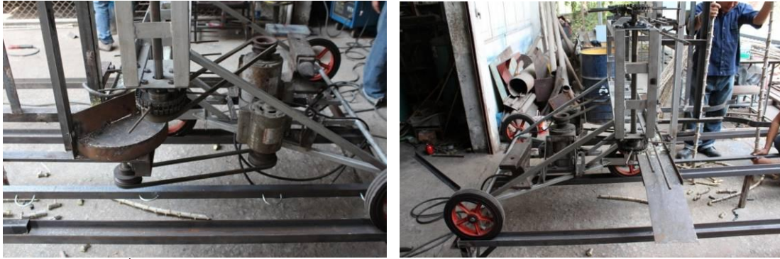
รูปที่ 6 ระบบส่งกำลังขับเคลื่อนชุดใบมีด (ซ้าย) และชุดลำเลียงต้นออกด้านข้าง(ขวา)
