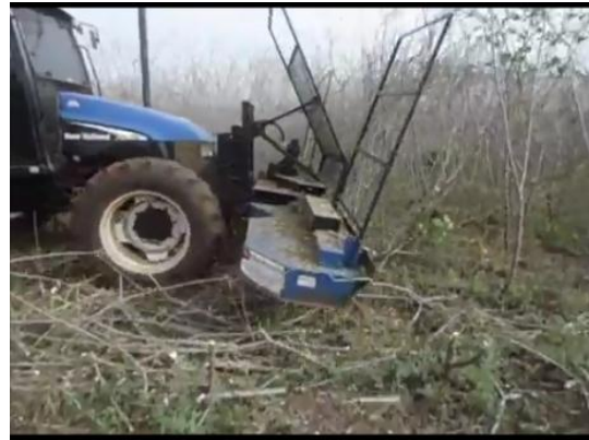
รูปที่ 2 เครื่องตัดต้นมันสำหหลังแบบติดตั้งหน้ารถแทรกเตอร์ของต่างประเทศแบบที่ 2
