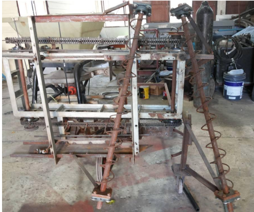
รูปที่ 10 ส่วนการป้อนเข้าสู่การตัดแบบเกลียวลำเลียงคล้ายรถตัดอ้อย
