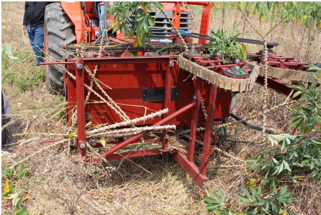
รูปที่ 16 ความเร็วชุดลำเลียงช้าเกินไปเกิดการอัดตัวที่หน้ารางลำเลียง
