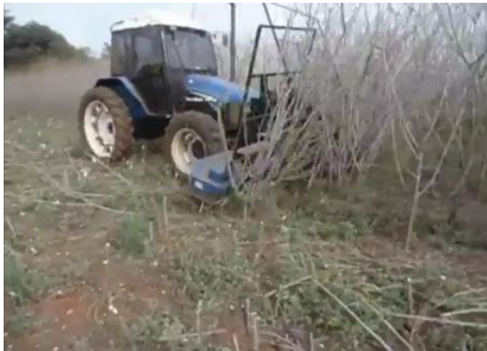
รูปที่ 2 เครื่องตัดต้นมันสำหหลังแบบติดตั้งหน้ารถแทรกเตอร์ของต่างประเทศแบบที่ 2
