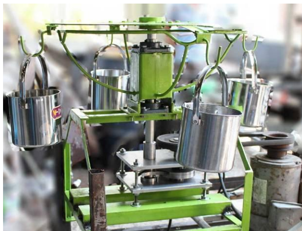
รูปที่ 11 ตำแหน่งการหยุดของส่วนกระบวนการซึ่งเพื่อในไปสู่กระบวนการหาค่าความถ่วงจำเพาะ
