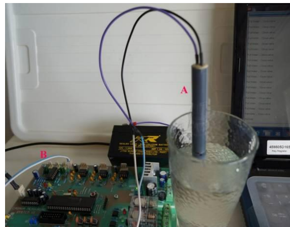
รูปที่ 4 การทดลองการตรวจวัดวัสดุที่เคลื่อนที่เข้ามายังสถานี เพื่อส่งสัญญาณไปควบคุมการซัง
