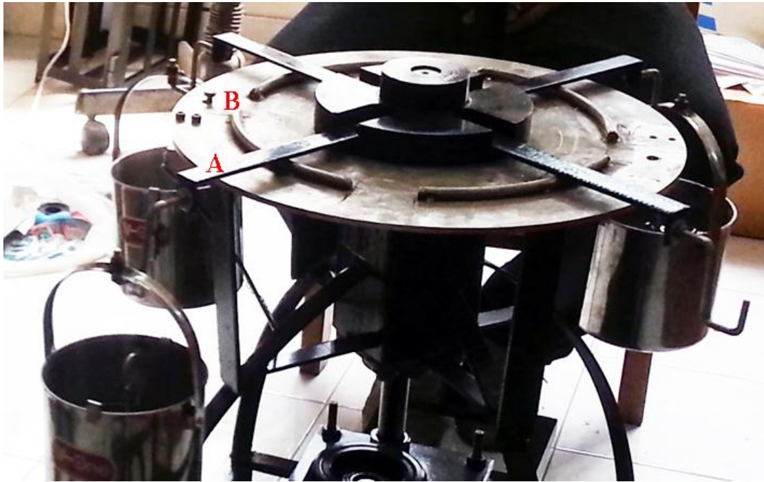
รูปที่ 19 อุปกรณ์ส่งถ่ายน้ำหนั; (A) คานรับน้ำหนั, (B) เต็ยรับน้ำหนัต่อกับโหลดเซล
