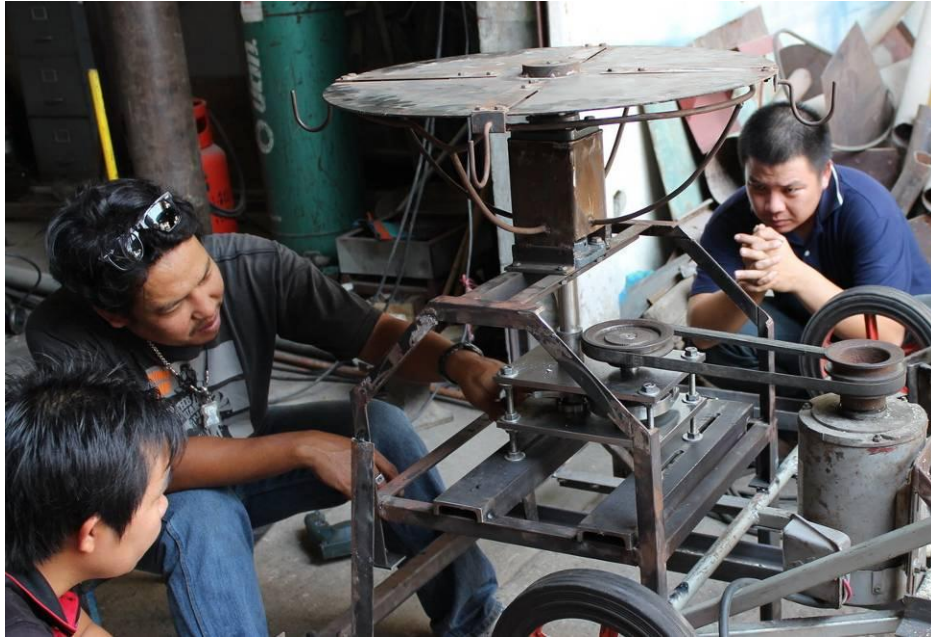
รูปที่ 13 ทดสอบหลักการทำงาน และวิเคราะห์ปัญหาการหยุดไม่ตรงตำแหน่งที่ออกแบบ
