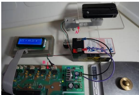
รูปที่ 6 การทดสอบระบบตรวจวัดน้ำหนักเบื้องต้น, load cell (A) and weighing circuit (B)
