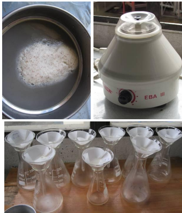
รูปที่ 3 กรองเอากากออก เข้าเครื่องแยกตะกอน แล้วนำไปกรองด้วยกระดาษกรองเอาน้ำออก และนำไปอบให้แห้ง
