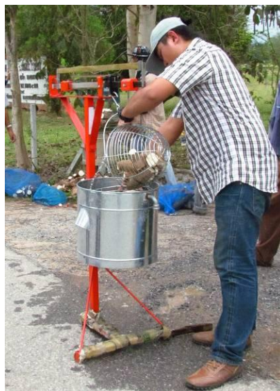
รูป 1 เครื่องวัดเปอร์เซ็นต์แบ่งมันสำปะหลังที่ใช้ในระบบซื้อขายปัจจุบัน
