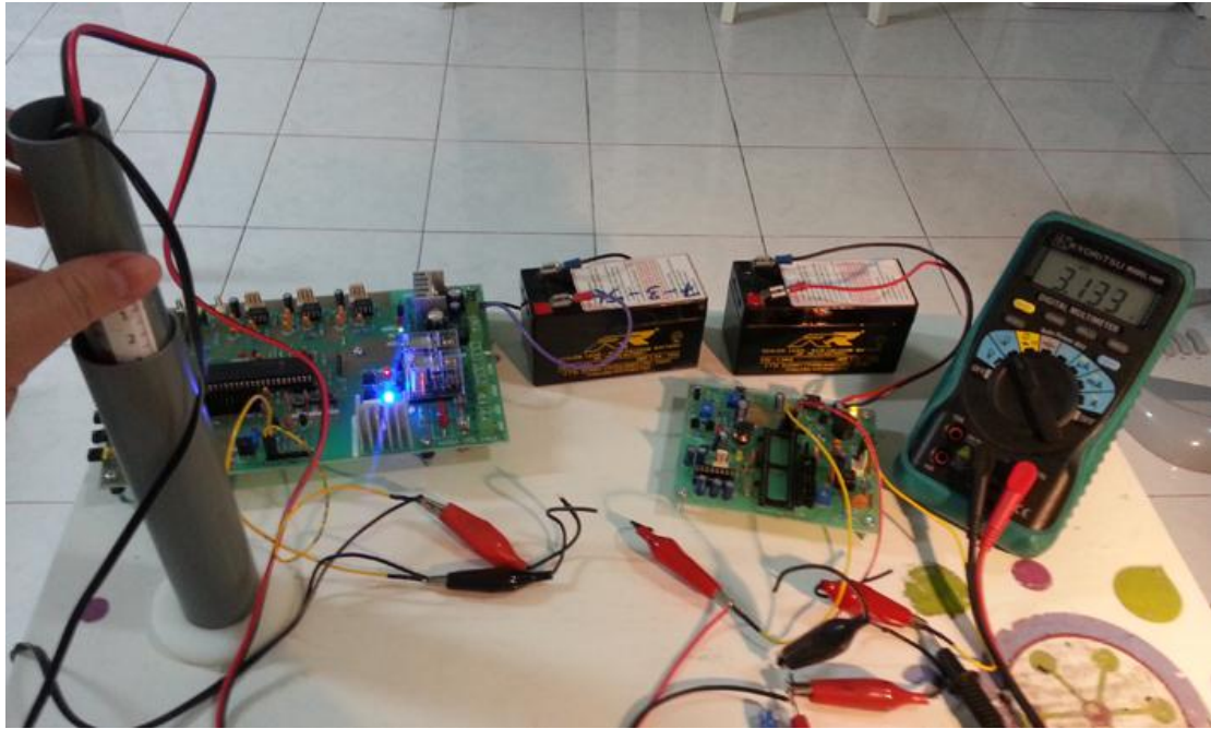
รูปที่ 17 การทดสอบหัวเซ็นเซอร์รับส่งแสงอินฟราเรด
