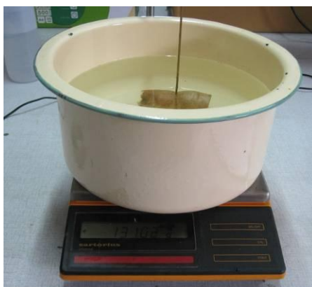
รูปที่ 2 ชั่งหัวมันสำปะหลังในน้ำเพื่อหาน้ำหนักของน้ำที่มีปริมาตรเท่ากับหัวมันสำปะหลัง
