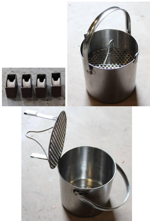
รูปที่ 14 ล้อเลื่อนรับแขนซึ่ง (ซ้ายสุด) และภาชนะสำหรับบรรจุตัวอย่างพร้อมฝาปิด-เปิด
