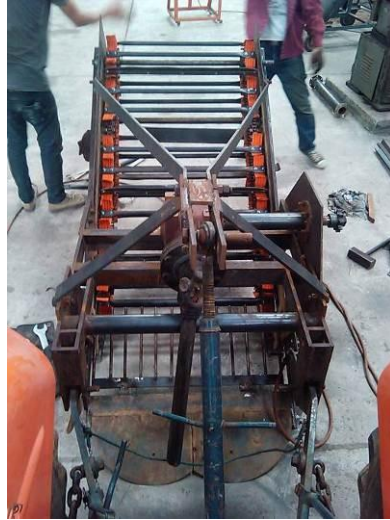
ภาพที่ 12 เครื่องเก็บเหง้ามันสำปะหลังติดท้ายรถแทรกเตอร์ใช้หัวเก็บแบบผลจานครึ่งซีกวางคู่ ส่งขึ้นสายพานโซ่ลำเลียง
