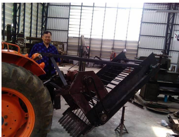
ภาพที่ 11 เครื่องเก็บเหง้ามันสำปะหลังติดท้ายรถแทรกเตอร์ใช้ชุดเก็บเป็นซี่เหล็ก ส่งขึ้นสายพานโซ่ลำเลียง
