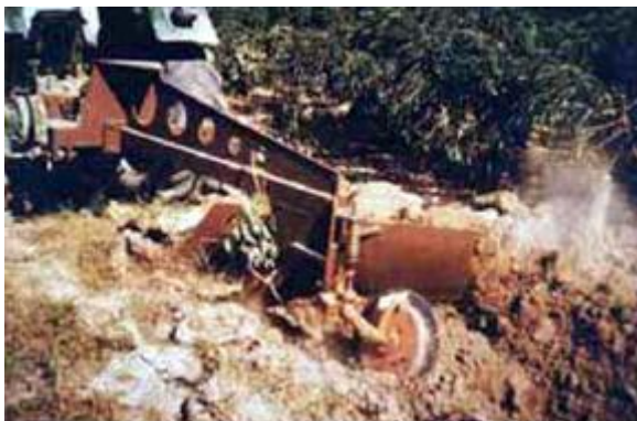
ภาพที่ 2 เครื่องขุดมันสำปะหลังแบบคันเดียว
