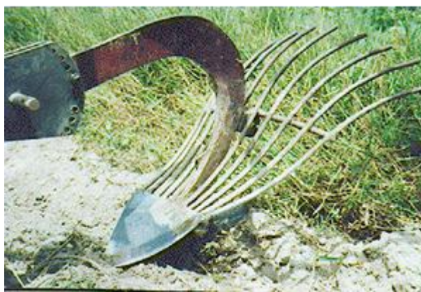
ภาพที่ 4 เครื่องชุดมันฝรั่งติดรถไถเดินตาม
