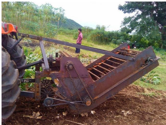
ภาพที่ 14 เครื่องเก็บเหง้ำมันสำปะหลังติดท้ายรถแทรกเตอร์ใช้หัวเก็บแบบผาลจานครึ่งซีกเดียว พร้อมลูกกลิ้งช่วยส่งขึ้นสายพานโซ่ลำเลียง
