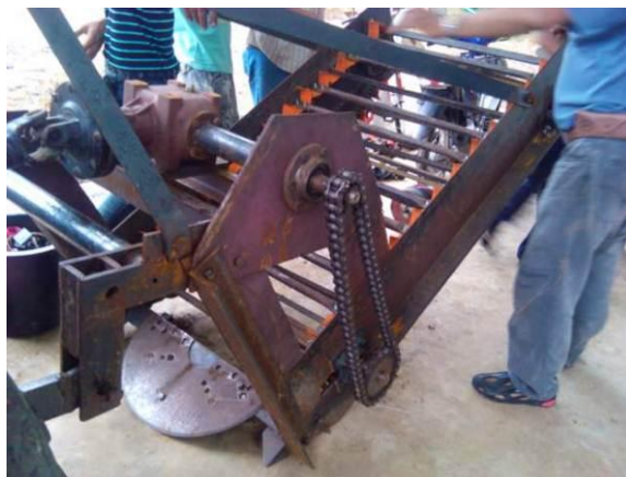
ภาพที่ 13 เครื่องเก็บเหง้ามันสำปะหลังติดท้ายรถแทรกเตอร์ใช้หัวเก็บแบบผลจานครึ่งซีกเดี่ยว ส่งขึ้นสายพานโซ่ลำเลียง
