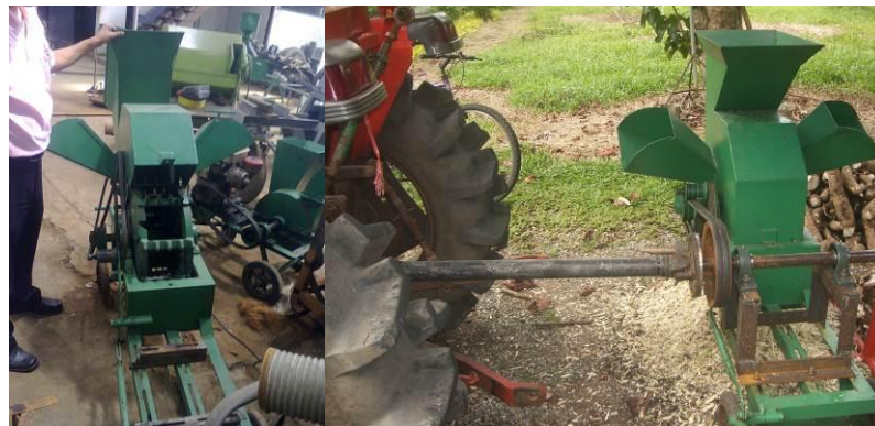
ภาพที่ 17 เครื่องเครื่องย่อยเหง้ามันสำปะหลัง ของสถาบันวิจัยเกษตรวิศวกรรม กรมวิชาการเกษตร
