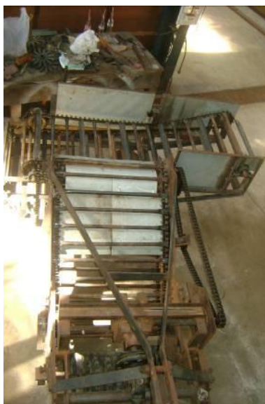
ภาพที่ 15 สายพานโซ่ลำเลียงชุดที่สองวางขวางรับชุดแรกเพื่อลำเลียงลงกระบะพ่วง หรือเทเลอร์ที่ใช้ขนถ่าย
