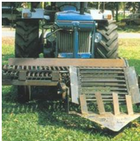
ภาพที่ 3 เครื่องชุดมันสำปะหลังชนิดติดหน้ารถแทรกเตอร์
