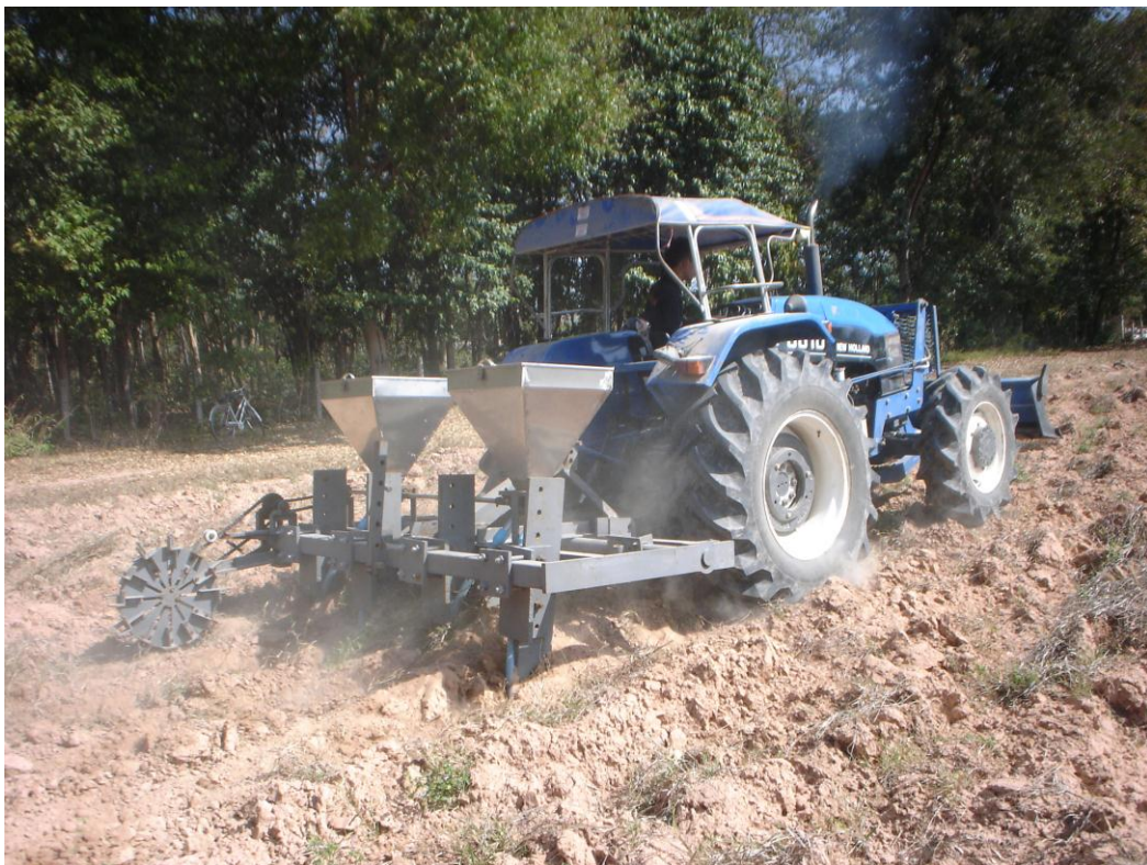
รูปที่ 3-19 การทดสอบหยอดปุ๋ยเคมีในแปลงทดสอบ
