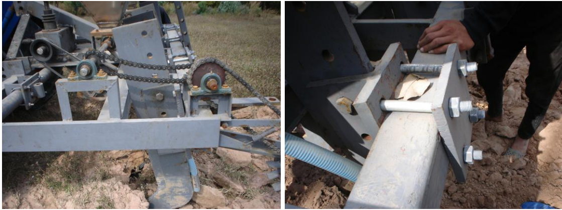
รูปที่ 3-22 ความเสียหายที่เกิดจากลักษณะดินที่แข็งมากๆ และแห้ง
