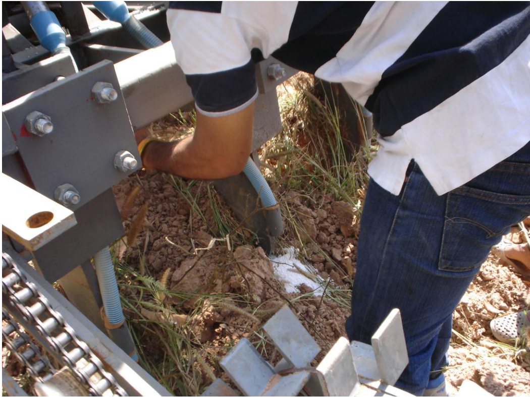
รูปที่ 3-20 การปรับแต่งเนื่องจากท่อปุ๋ยตัน
