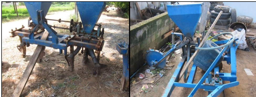
รูปที่ 13 เครื่องฝัງปุ๋ยที่ผลิตในท้องถิ่น
