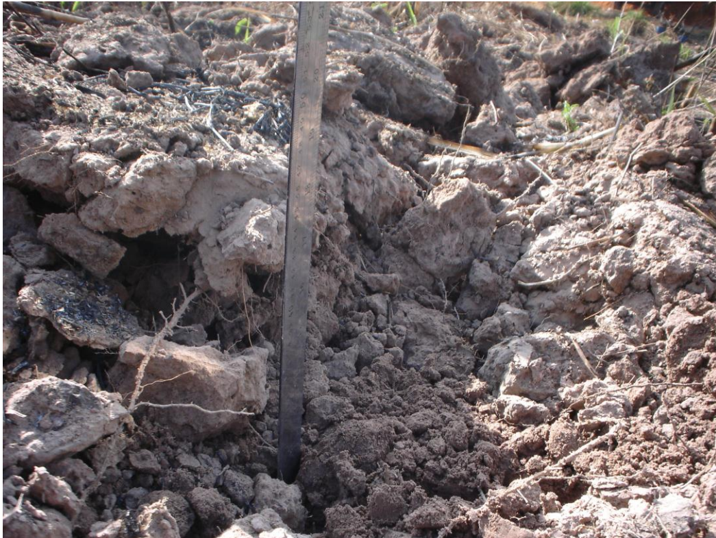
รูปที่ 3-28 ลักษณะการแตกของดินและระดับความลึกหลังจากเปิดดินตาม 30 เซนติเมตร
