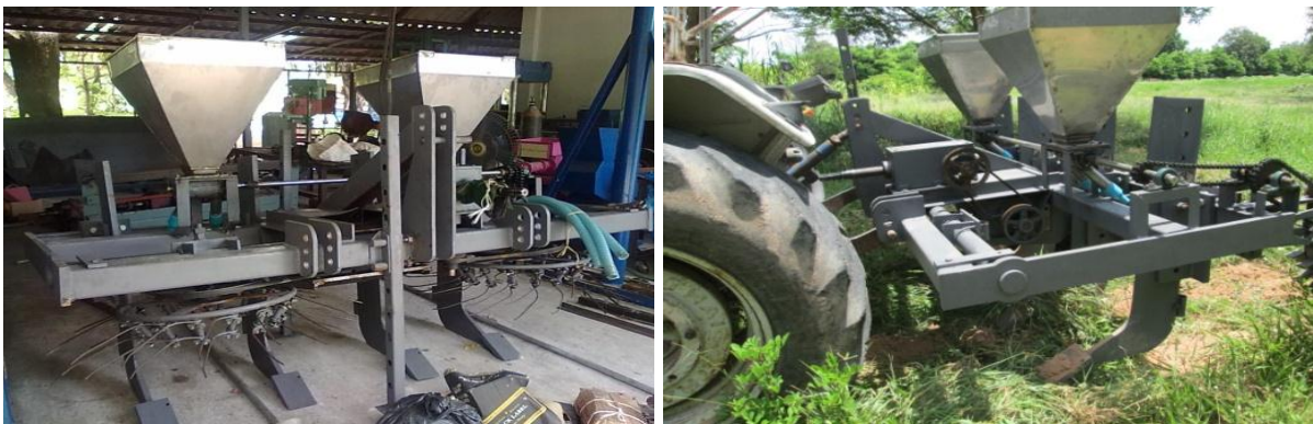
รูปที่ 3-5 การทดสอบเครื่องต้นแบบในห้องทดลองในศูนย์วิจัยเกษตรวิศวกรรมขอนแก่นที่มีระยะดินดานที่ 15 เซนติเมตร ด้วยแทรกเตอร์ 60 แรงม้า
