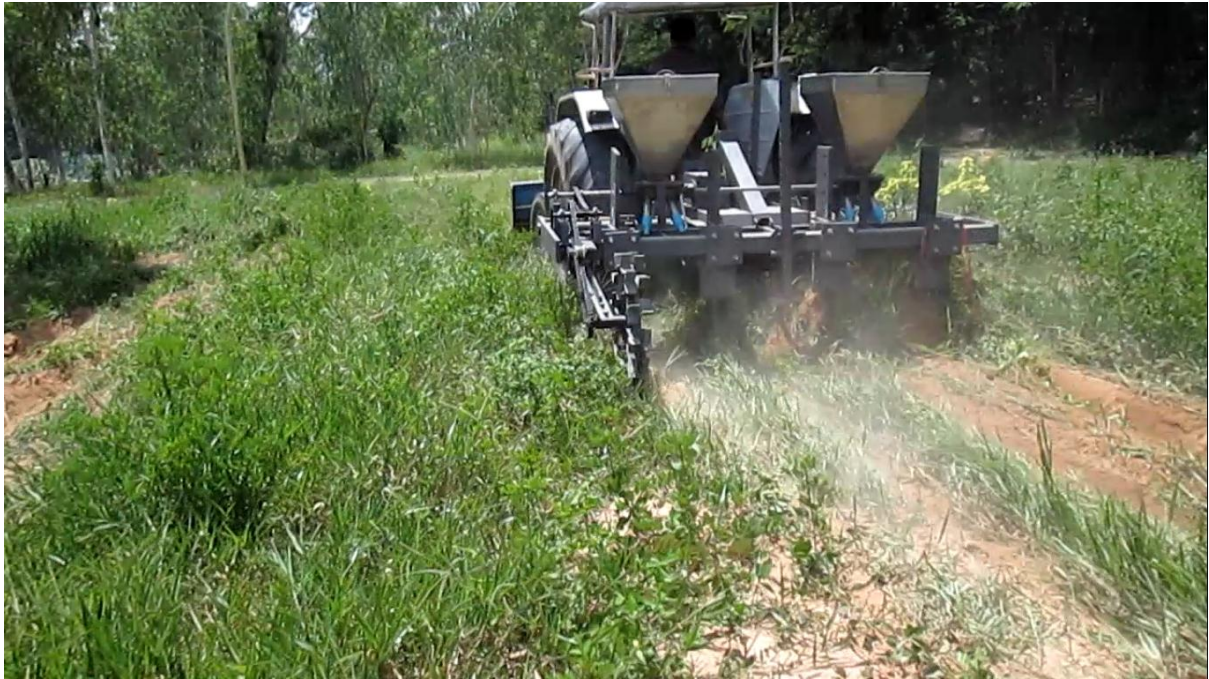
รูปที่ 3-6 การทดสอบเครื่องต้นแบบยังประสบปัญหาเรื่องหญ้าในแปลงทดลองและต้นกำลังที่มีขนาดต่ำ ซึ่งจะติดบางช่วงที่ลงลึก และเมื่อขุดลงไปการไถไม่ถึงชั้นดินดาน
