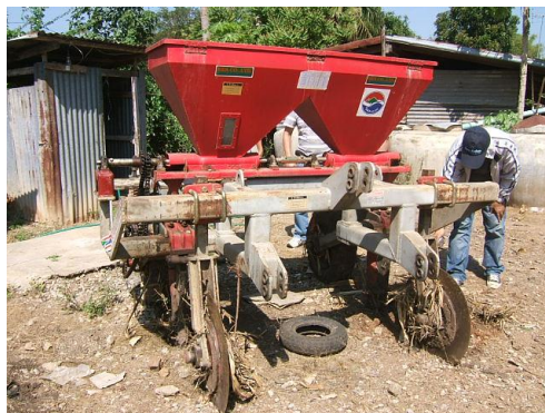
รูปที่ 2-5 เครื่องฝัງปุ๋ยแบบ 2 แถว ติดล้ออัดดิน
