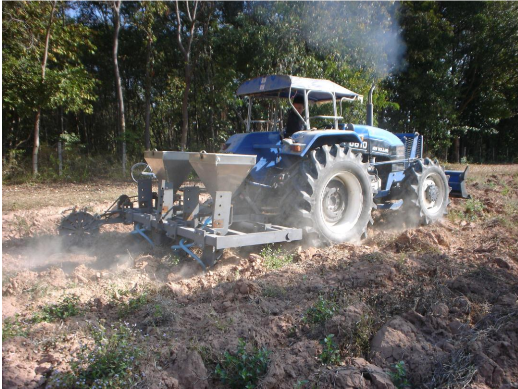
รูปที่ 3-13 ลักษณะการทดสอบโดยใช้เกียร์ Low 2 ที่ต้องเร่งเครื่องยนต์มาก
