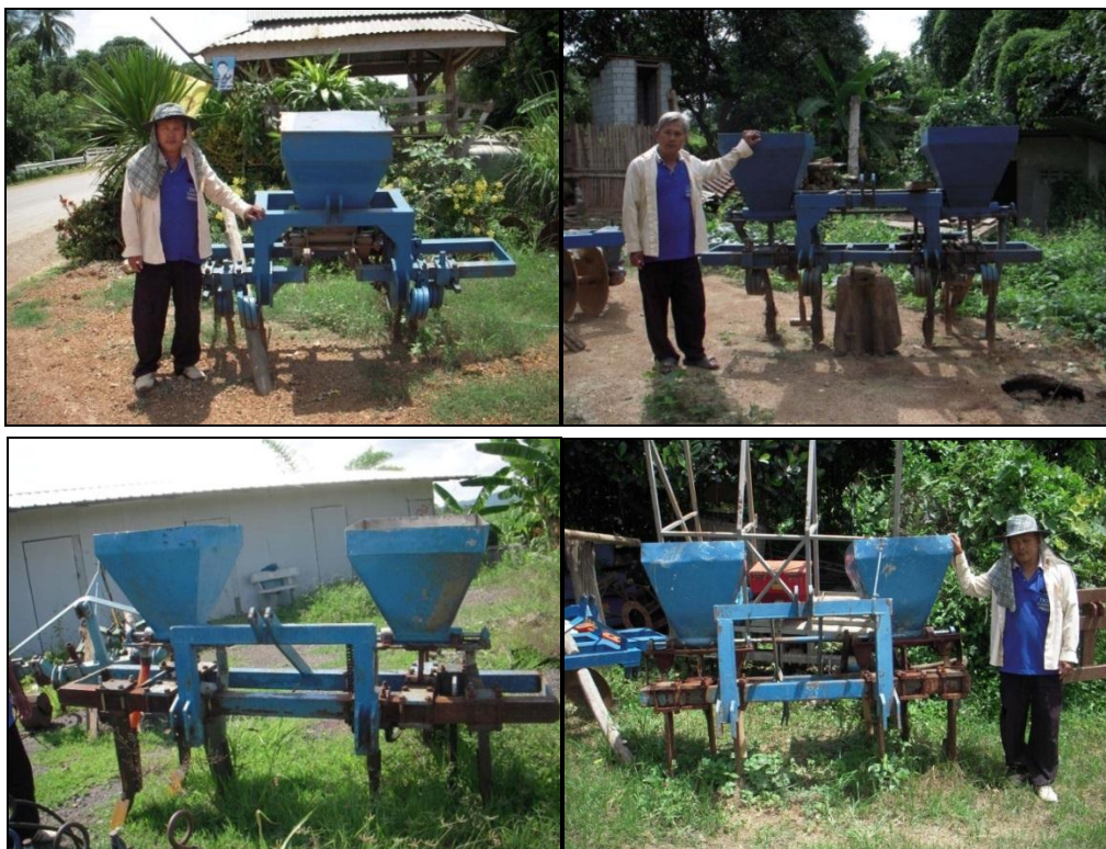
รูปที่ 8 เครื่องฝังปุ๋ยที่ผลิตในจังหวัดอุดรดิตถ์
