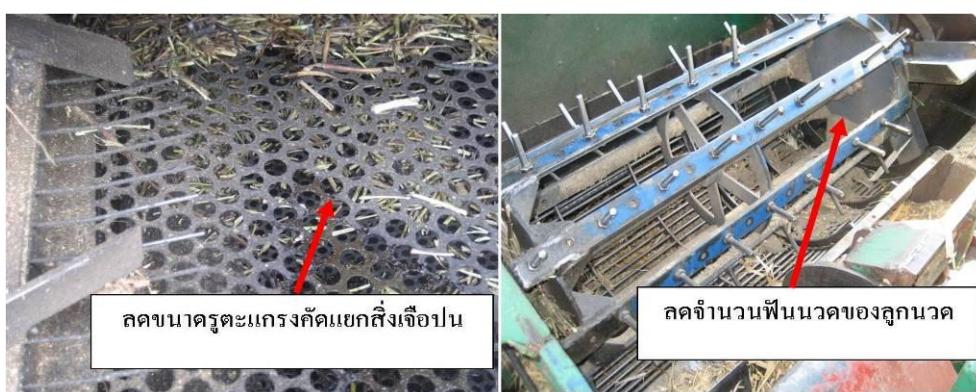
ภาพที่ 1.6 ตะแกรงคัดแยกกากและสิ่งเจือปนออกจากเมล็ดข้าวที่ผ่านระบบนวด
