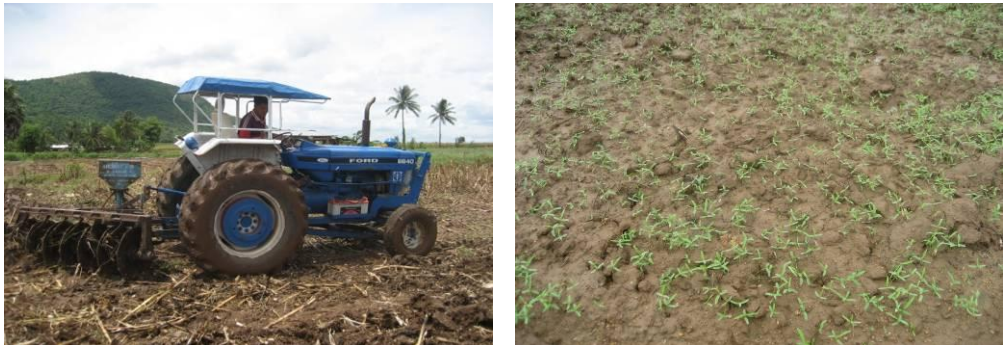
ภาพที่ 1.1 เครื่องหว่านแบบติดพ่วงรถไถพร้อมคราดกลบเมล็ด
