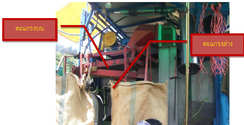
ภาพที่ 1.9 ตำแหน่งที่ติดตั้งเพิ่มเติมของตะแกรงคัดสำหรับเกี่ยวมัดถั่วเขียว
