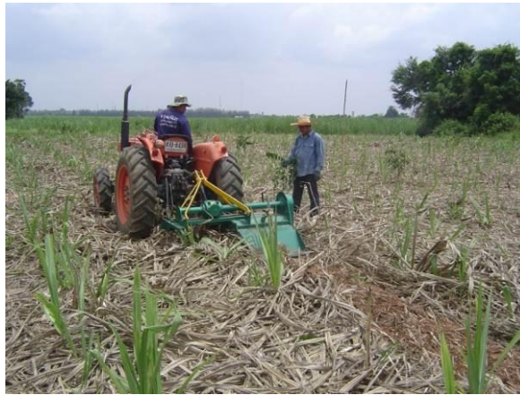
รูปที่ 10 การทดสอบต้นแบบติดพวงกับรถแทรกเตอร์ 34 แรงม้า
