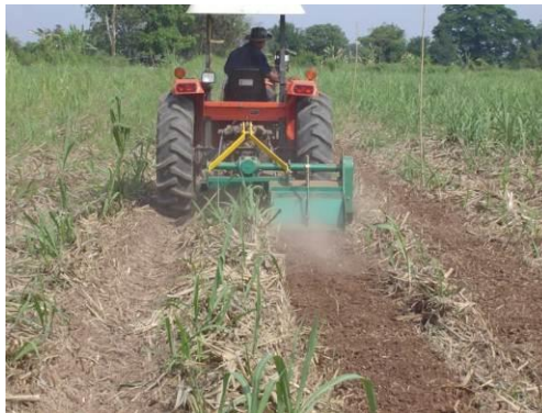
รูปที่ 6 ทดสอบสับกลบใบอ้อยที่มีความหนาระหว่าง 10-15 เซนติเมตร
