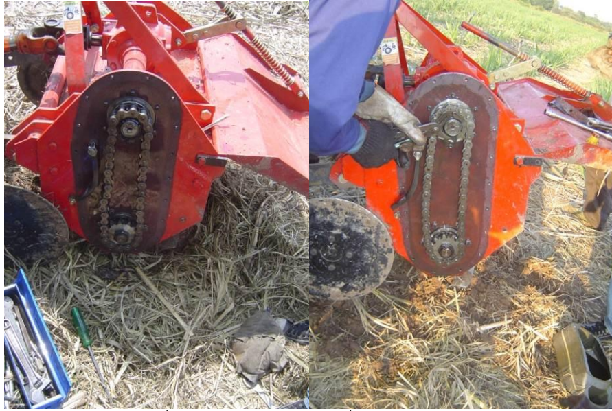
รูปที่ 14 การทดลองสลับเปลี่ยนเฟืองในท้องโซ่
