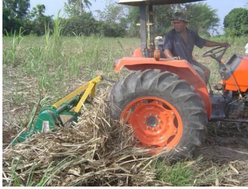
รูปที่ 7 ปัญหาที่เกิดจากใบอ้อยหนาเกิน 15 เซนติเมตร
