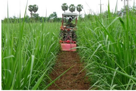
รูปที่ 18 ทดสอบจอบหมุนกำจัดวัชพืชติดพวงรถแทรกเตอร์ขนาด 24 แรงม้า
