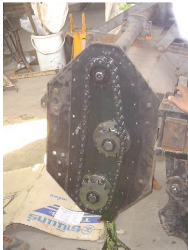
รูปที่ 31 แสดงการใช้โซ่ขับเคลื่อนลูกตีหมุนตามกัน
