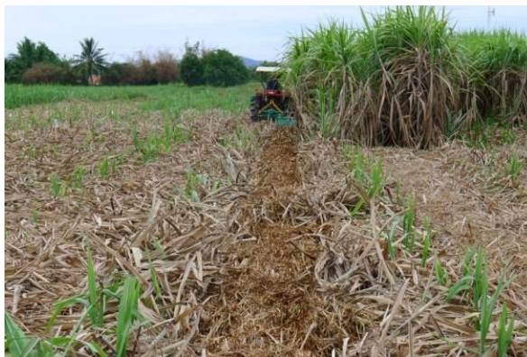
รูปที่ 11 จอบหมุนสับกลบใบอ้อยติดพวงกับ kubota L 3408
