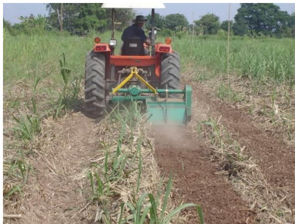
รูปที่ 3 ต้นแบบจอบหมุนสำหรับสับกลบใบอ้อยต้นแบบที่ 1
