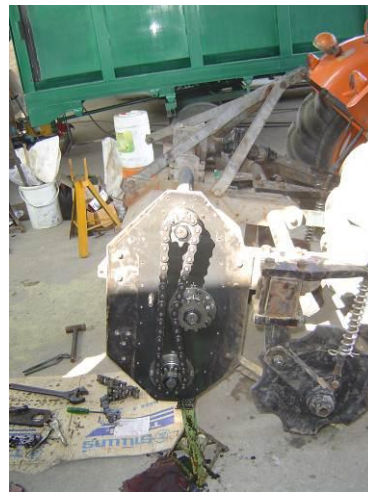
รูปที่ 31 แสดงการใช้โซ่ขับเคลื่อนลูกตีหมุนตามกัน
