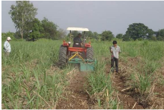
รูปที่ 15 ทดสอบจอบหมุนสับกลบใบอ้อยติดพ่วงรถแทรกเตอร์ 50 แรงม้า
