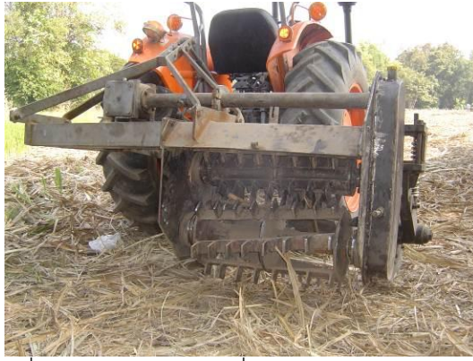
รูปที่ 30 แสดงต้นแบบเครื่องสับไป๋อ้อยแบบ 2 ลูกตี
