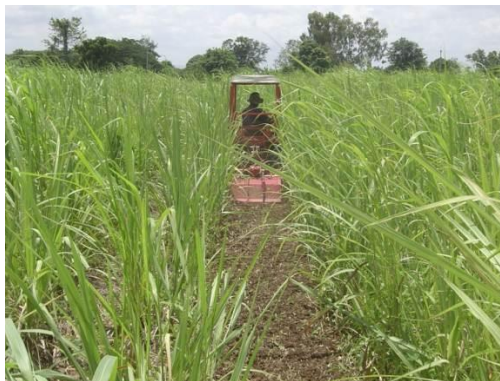
รูปที่ 17 ทดสอบจอบหมุนสับกลบใบอ้อยติดพ่วงรถแทรกเตอร์ขนาด 24 แรงม้า
