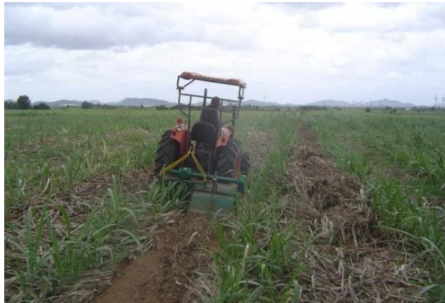
รูปที่ 16 ทดสอบจอบหมุนสับกลบใบอ้อยติดพ่วงรถแทรกเตอร์ขนาด 34 แรงม้า
