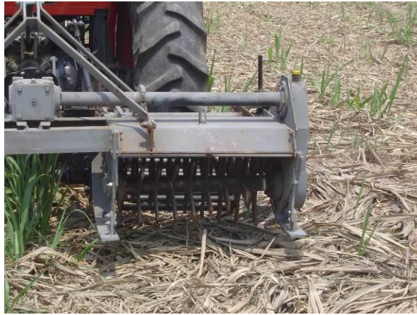
รูปที่ 26 ชดลูกตีมีลักษณะเป็นเหล็กพืดแบน
