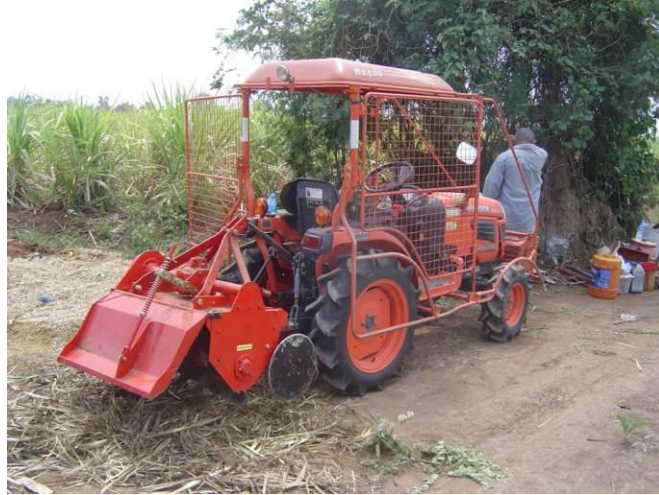
รูปที่ 13 ต้นแบบจอบหมุนสับกลบใบอ้อยสำหรับรถแทรกเตอร์ 24 แรงม้า
