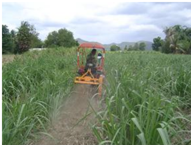
รูปที่ 41 แสดงผลการทำงานเครื่องสับใบอ้อยพ่วงแทรกเตอร์ 24 แรงม้า
