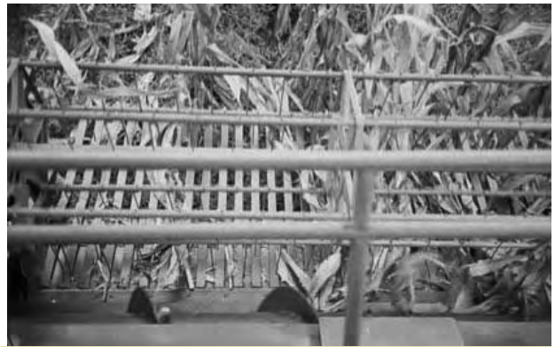
ภาพที่ 27 แผงซี่เหล็กแบนยึดต่อขยายเพิ่มความยาวของกระบะของหัวเกี่ยวไปทางด้านหน้า
