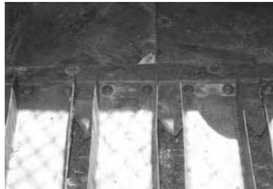
ภาพที่ 30 การจับยึดแผงซี่เหล็กแผ่นพับขึ้นขอบสำหรับใช้เกี่ยวทานตะวันจากต่างประเทศ
