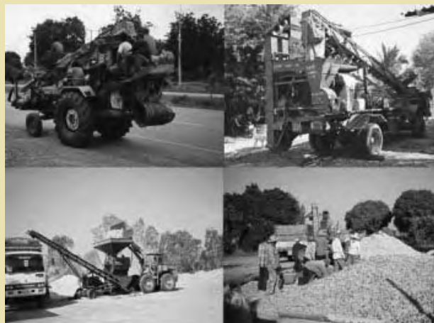
ภาพที่ 5 เครื่องกะเทาะข้าวโพดรับจ้างขนาดใหญ่มีขีดความสามารถในการทำงานมากกว่าชั่วโมงละ 10 ตัน
