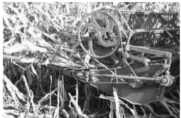
ภาพที่ 33 ต้นข้าวโพดเลี้ยงสัตว์ล้มบนแผงซี่เหล็กแบนและกระบะหัวเกี่ยวทวนดกึ่ง ของชุดล้อราวพาเขี่ยปัดอย่างมีประสิทธิภาพ
