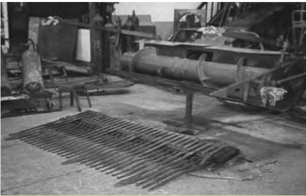
ภาพที่ 27 แผงซี่เหล็กแบนยึดต่อขยายเพิ่มความยาวของกระบะของหัวเกี่ยวไปทางด้านหน้า
