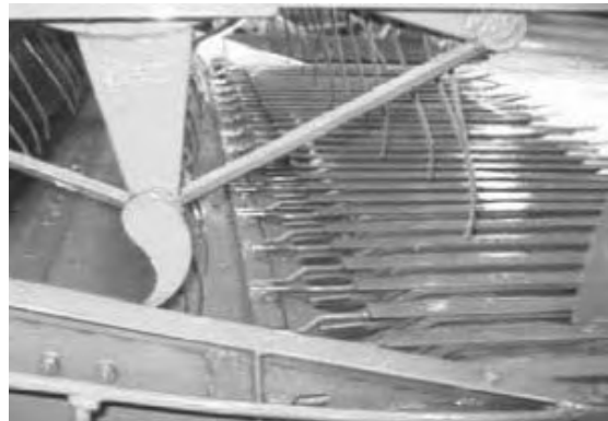
ภาพที่ 31 ซี่เหล็กแบนจับยึดติดกันเป็นคู่และยึดติดกับกระบะหัวเกี่ยวแบบเป็นอิสระต่อกัน
