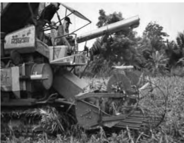
ภาพที่ 7 เครื่องเกี่ยวนวดข้าว “ไทย” ใส่ซี่เหล็กแบนแบบติดกันถาวรเป็นแผงใหญ่ หน้าชุดราวใบมีดตัดแบบต่างๆ
