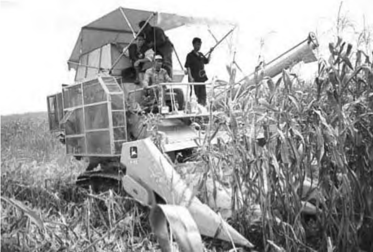
ภาพที่ 46 ต้นแบบเครื่องเกี่ยวข้าวโพดแบบ ขับเคลื่อนด้วยตนเอง แบบใช้หัวปลิดเฉพาะฝัก
