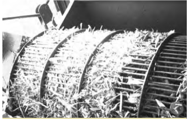
ภาพที่ 25 ต้นและฟักข้าวโพดอัดแน่นติดในตะแกรงขนาด
