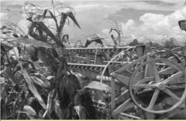
ภาพที่ 24 ล้อราวพาผลักดันข้าวโพดให้โน้มเอียงไปข้างหน้า
