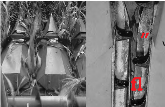
ภาพที่ 18 ลักษณะการผลิตและลำเลียงฝักข้าวโพดของหัว เกี่ยวที่นำเข้ามาจากต่างประเทศ
