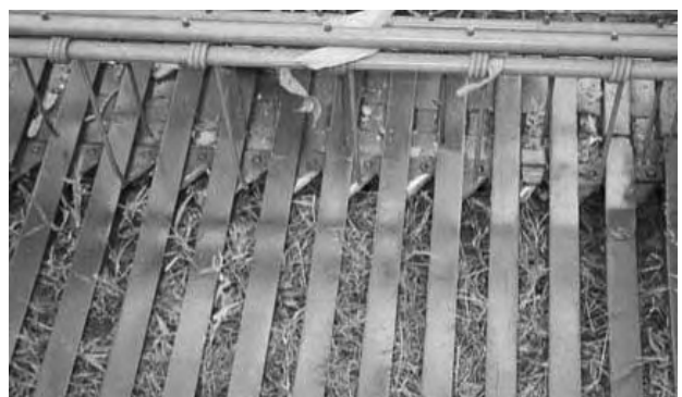
ภาพที่ 29 เหล็กพืดที่ใช้ทำซี่เหล็กแบนปิดบังการ์ดของใบมีด
