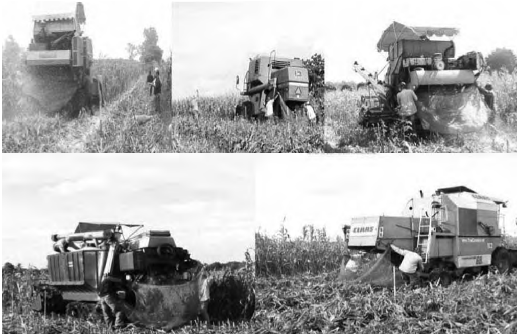
ภาพที่ 21 การทดสอบประสิทธิภาพการทำงานของเครื่องเกี่ยวนวดข้าวโพดที่มีการใช้งานอยู่ ทั้ง 3 แบบ
