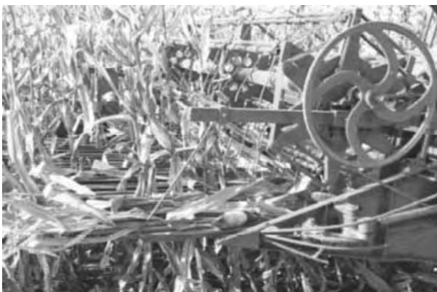
ภาพที่ 33 ต้นข้าวโพดเลี้ยงสัตว์ล้มบนแผงซี่เหล็กแบนและกระบะหัวเกี่ยวทวนดกึ่ง ของชุดล้อราวพาเขี่ยปัดอย่างมีประสิทธิภาพ
