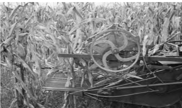
ภาพที่ 28 ต้นข้าวโพดสอดเข้าช่องห่างระหว่างซี่เหล็กแบน
