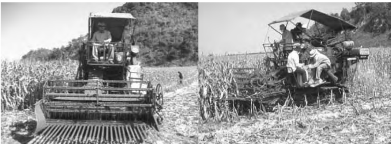
ภาพที่ 38 ต้นแบบเครื่องเกี่ยวข้าวโพดแบบขับเคลื่อนด้วยตนเอง แบบใช้ราวใบมีดตัดทั้งต้น
