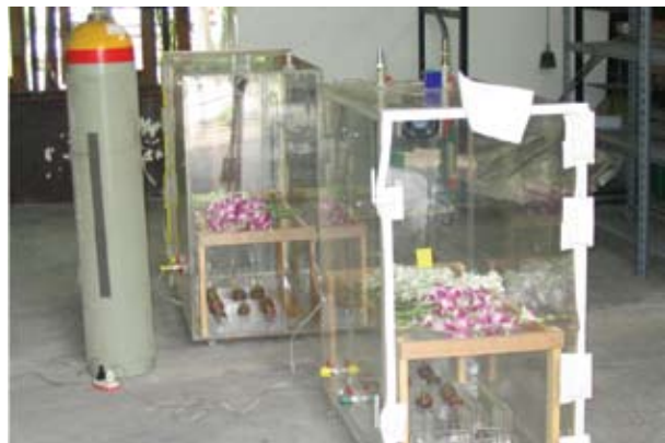
ภาพแสดง ตู้ทดลองขนาด 50x100x100 เซนติเมตร สำหรับรมสาร Eco 2 fume
