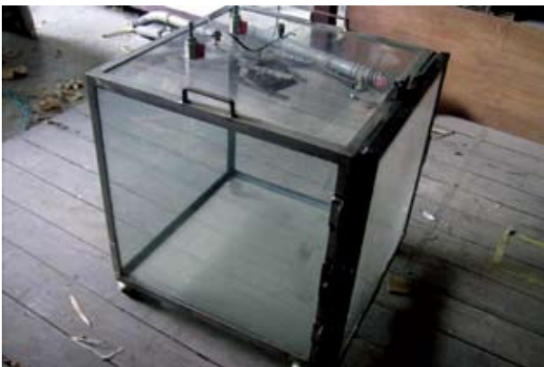
ภาพแสดง ตู้ทดลองขนาด 60x60x60 เซนติเมตร สำหรับรมสารเมทิลโบรไมด์
