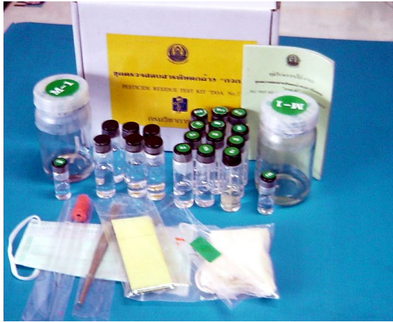
ชุดตรวจสอบสารตกค้างไซเปอร์เมทรินเบื้องต้น
