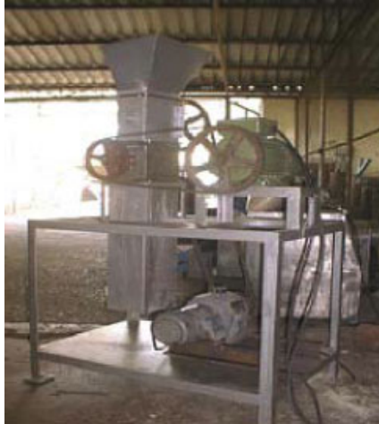
ภาพที่ 3 ชุดบดหยาบที่ออกแบบสร้างขึ้น พร้อมแบบแสดง
