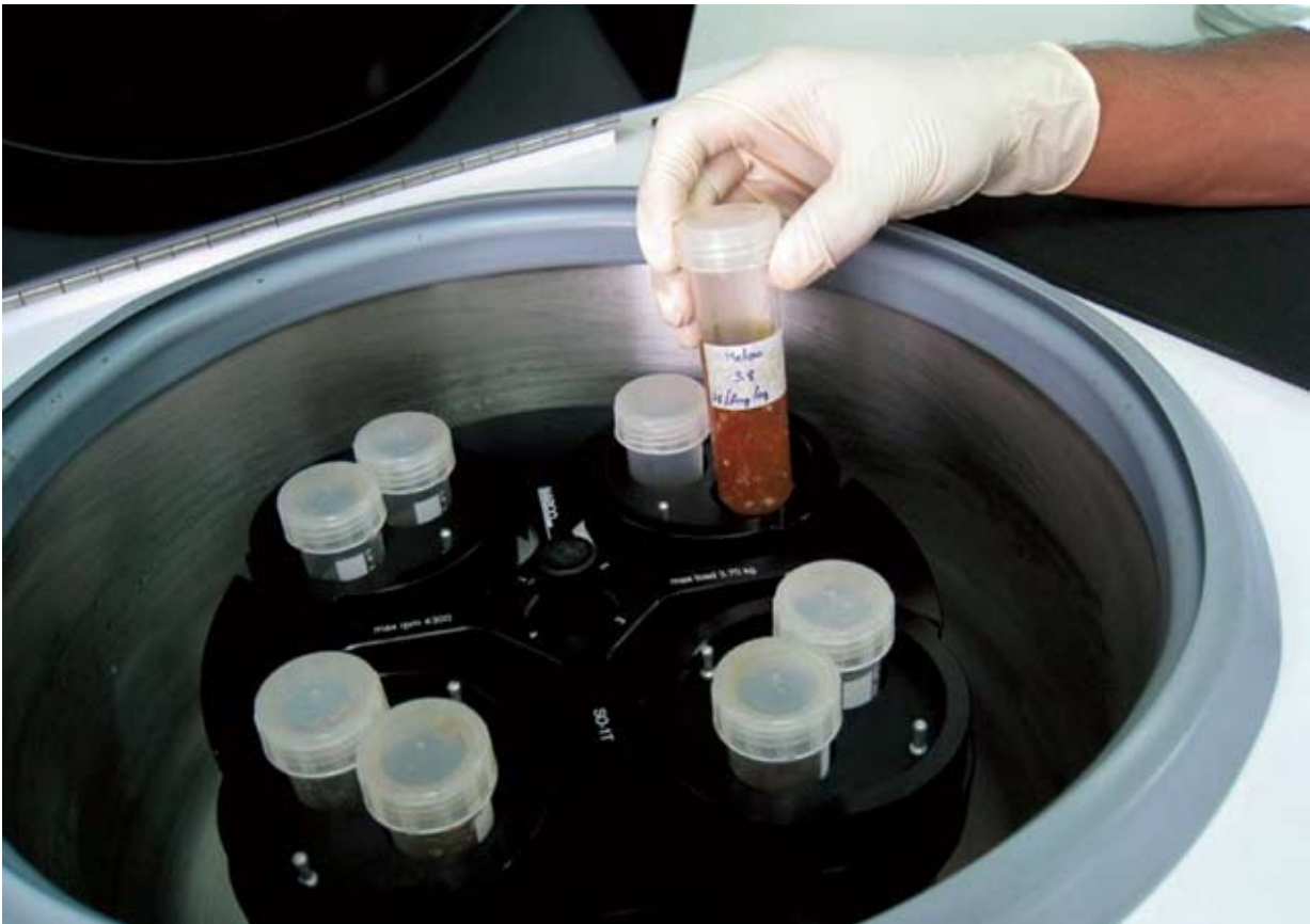
ภาพแสดง สกัดตัวอย่างด้วยเครื่องปั่นเหวี่ยง (Centrifuge)
