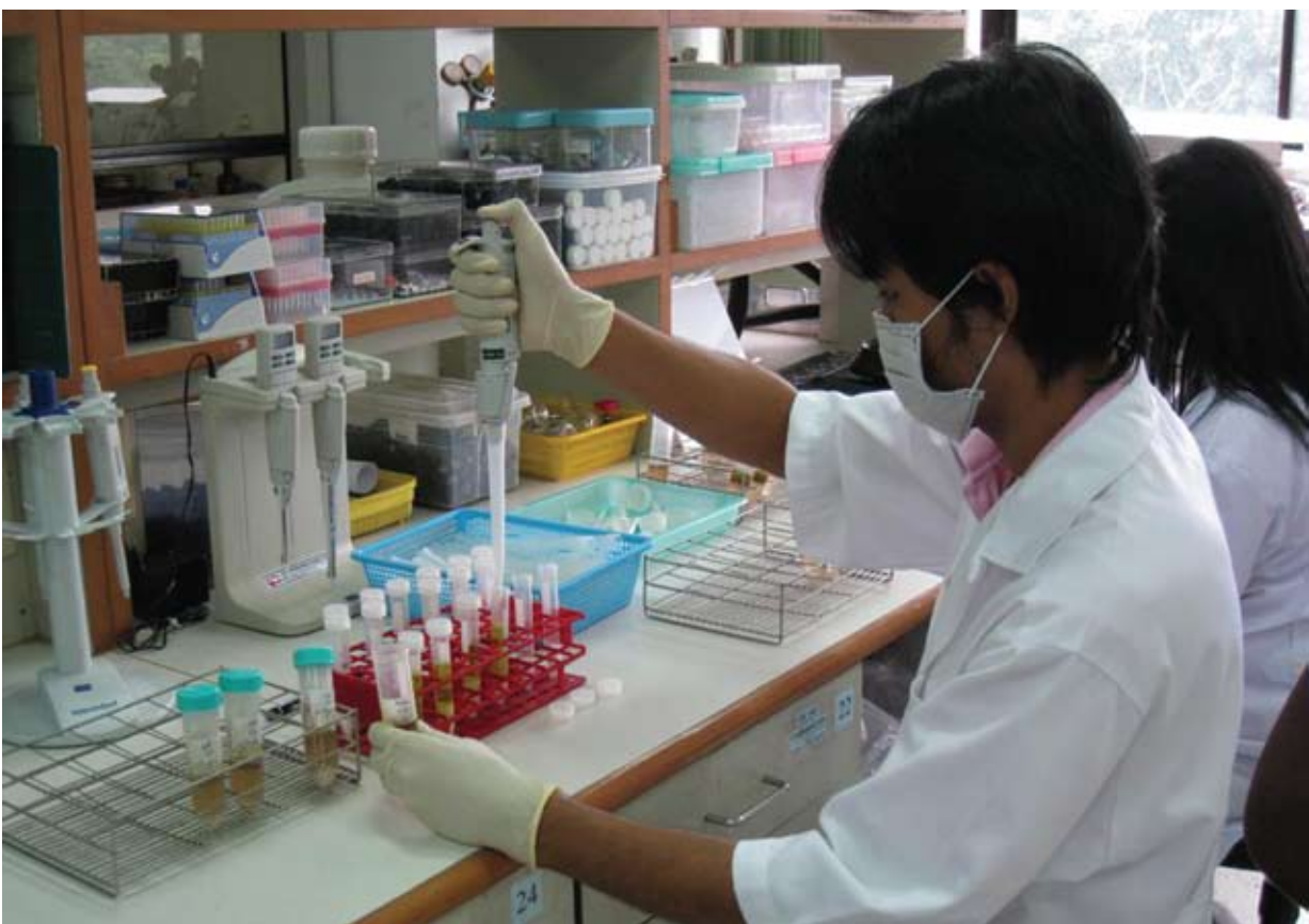
ภาพแสดง ดูดสารละลายตัวอย่างเพื่อนำไปกำจัดสิ่งปนเปื้อนโดยใช้ Dispersive-SPE Cleanup
