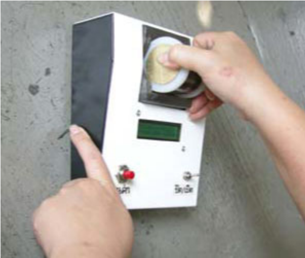
ภาพที่ 5 การใช้เครื่องวัดความชื้นลำไยอบแห้งทั้งเปลือก
