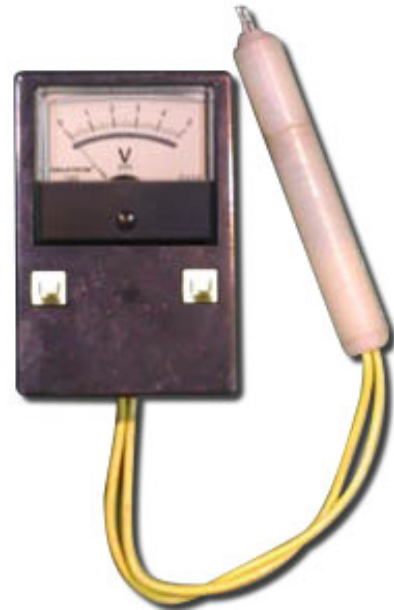
ภาพที่ 2 ต้นแบบเครื่องวัดความชื้นลำโอบแห้งทั้งเปลือกแบบความต้านทานไฟฟ้ามีหัววัดแบบเสียบ และแสดงแบบ Analog
