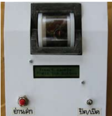
ภาพแสดง เครื่องมือวัดความชื้นลำไยอบแห้งทั้งเปลือก ระหว่างการใช้งาน
