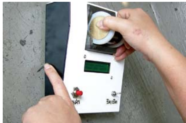
ภาพแสดง การใช้เครื่องวัดความชื้นลำไยอบแห้งทั้งเปลือก
