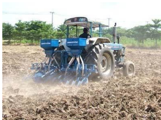
การทดสอบเครื่องหยอดข้าวและเครื่องหว่านข้าวแห้ง
