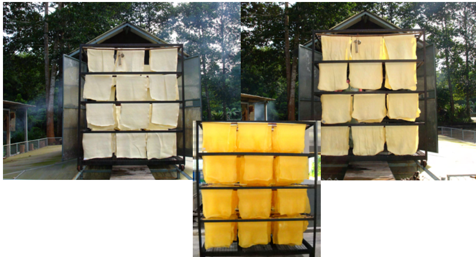
ภาพที่ 8 ยางแผ่นอบแห้งที่อบในโรงอบยางพลังงานแสงอาทิตย์ร่วมกับเตาเผาระยะเวลาไม่เกิน 4 วันในช่วงที่มีฝน
