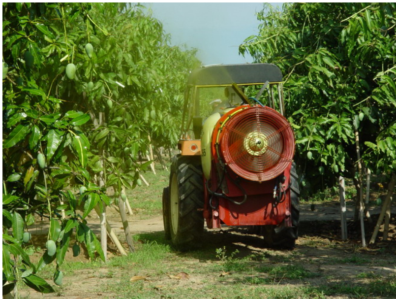
ภาพที่ 2 การพ่นสารป้องกันกำจัดโรคแอนแทรกคโนสในมะม่วงด้วยเครื่องยนต์พ่นสารแบบใช้แรงลมขนาดใหญ่
