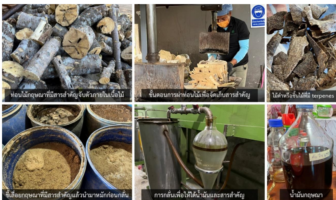
ภาพที่ 9 กระบวนการแปรรูปกฤษณาเป็นชิ้นไม้ (chip) และน้ำมัน (oil)
