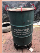
ถังนึ่งข้าวเชื้อระบบอัตโนมัติขนาด 200 ลิตร ภายในถังนี้ฆ่าเชื้อ
