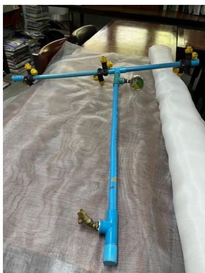
ภาพที่ 2 การพ่นสารด้วยเครื่องยนต์พ่นสารสะพายหลังแบบแรงดันน้ำสูง ประกอบกันฉีดแบบคานคู่แนวตั้ง 2 ด้าน ใช้หัวฉีดแบบพัด
