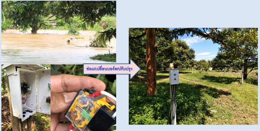
การซ่อมแซม/เปลี่ยนอุปกรณ์ที่เกิดความเสียหายจากน้ำท่วมแปลงเรียนรู้ที่อำเภอแก่งหางแมว
