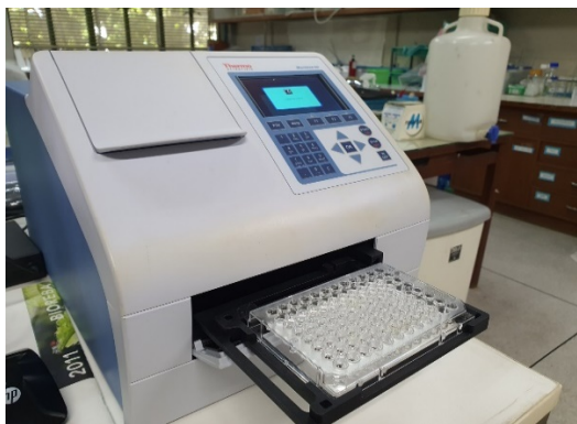
ภาพที่ 1 วัดค่าสีด้วย เครื่อง ELISA reader (Thermo Scientific Multiskan GO with cuvette port, Finland)
