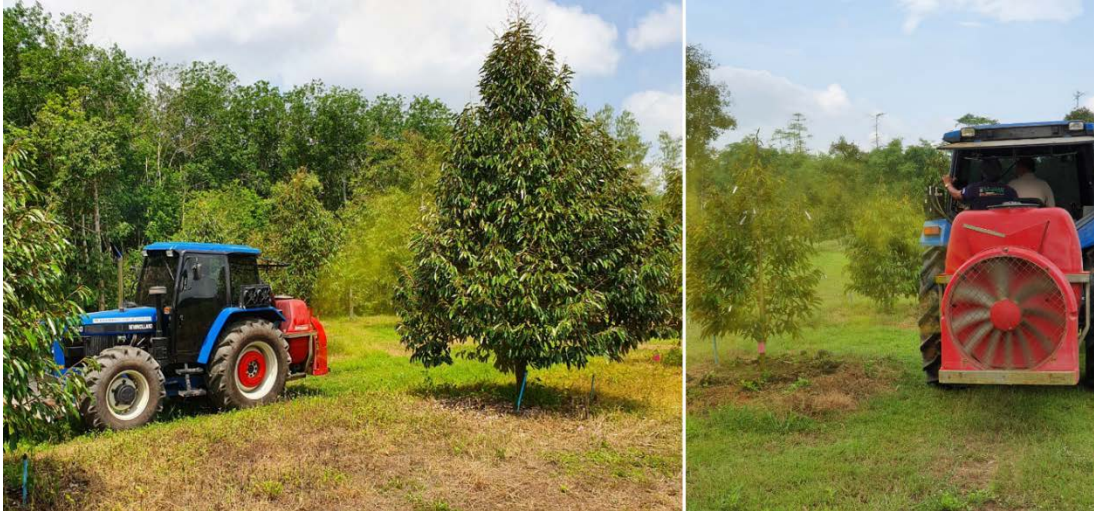
ภาพที่ 1 การพ่นสี Kingkol tartrazine 1% ด้วยเครื่องยนต์พ่นสารแบบแรงลม (Airblast sprayer)
