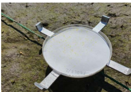
ภาพที่ 2 การดำเนินการศึกษาการปลิวของละอองสารนอกพื้นที่เป้าหมาย และการหาความหนาแน่นของละอองสารบนพื้นที่เป้าหมาย ที่นาข้าว อ.สามชุก จ.สุพรรณบุรี
