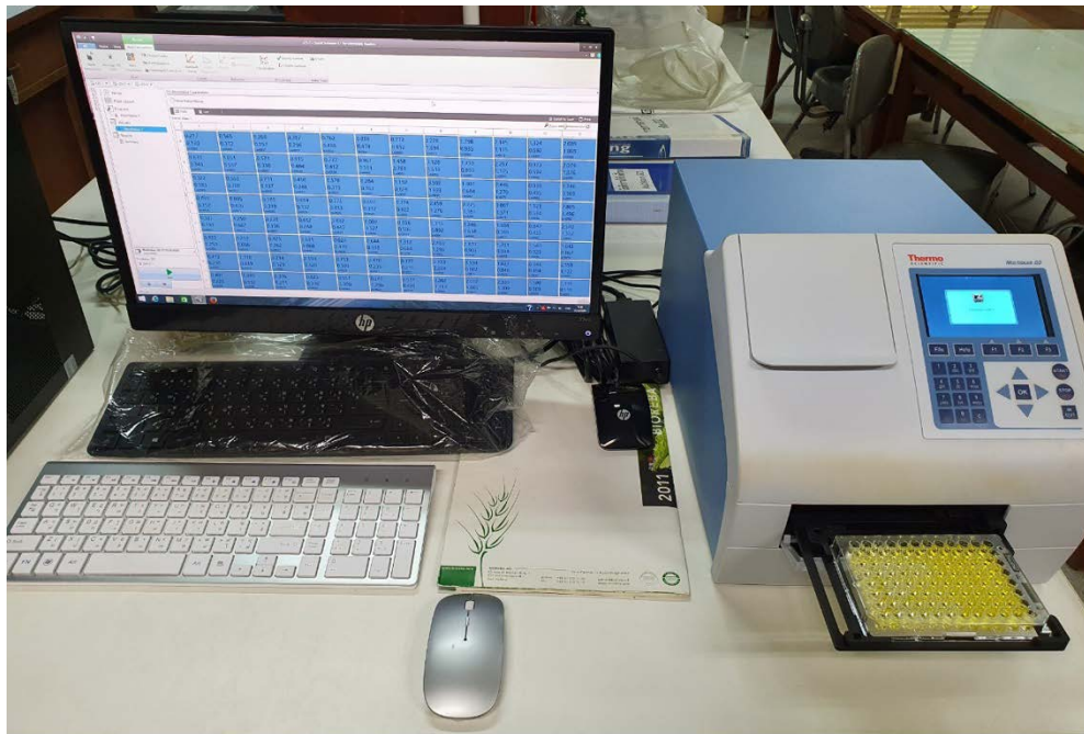
ภาพที่ 3 การวัดค่าความเข้มแสง (ค่า O.D. Optical density) ด้วยเครื่อง microplate spectrophotometer
