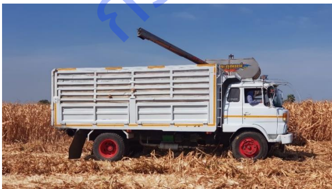
Figure 17 รถบรรทุกข้าวโพดลำเลียงส่งเมล็ดข้าวโพดผ่านท่อจากรถเกี่ยว
