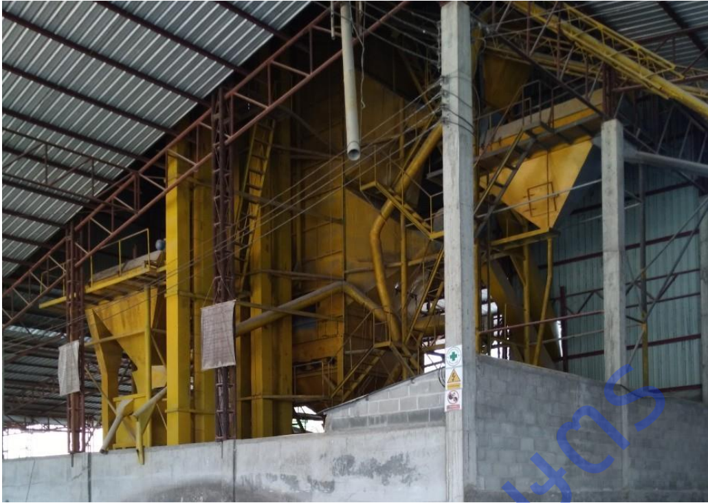
Figure 16 เครื่องอบลดความชื้นเมล็ด
