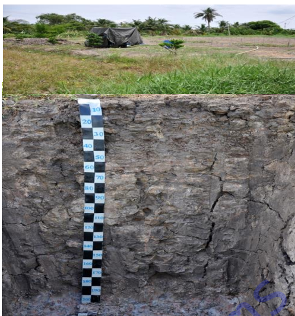
ภาพภาคผนวกที่ 1 สภาพแวดล้อมการใช้ที่ดินและหน้าตัดดิน (Soil Profile) แปลงข้าวโพดฝักอ่อน ในระบบเกษตรอินทรีย์ ณ แปลงเกษตรกร อำเภอนครชัยศรี จังหวัดนครปฐม ปี 2559
