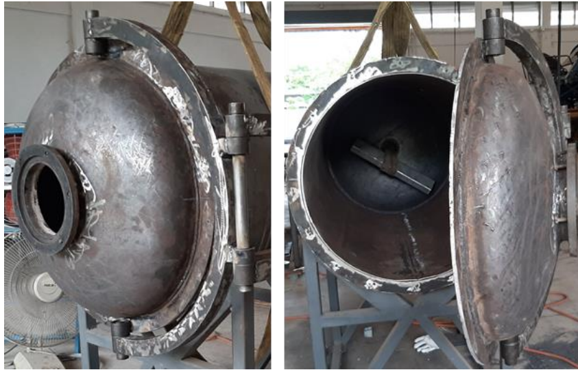
ภาพผนวก ข ที่ 3 ชั้นสุตรองรับการหมุน เปิด-ปิด ฝาถังอบแห้งสุญญากาศ
