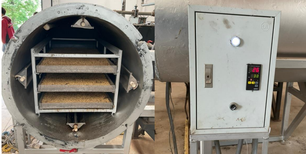
ภาพที่ 2.5 นำเมล็ดพันธุ์ถั่วเหลืองเข้าเครื่องอบลดแรงดันอากาศ ตั้งอุณหภูมิ 38 องศาเซลเซียส
