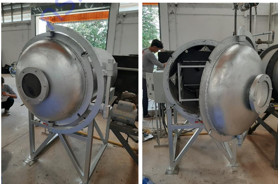
ภาพที่ 1.19 ฝา เปิด-ปิด ถังอบแห้งแบบลดแรงดันอากาศที่เสร็จสมบูรณ์แล้ว
