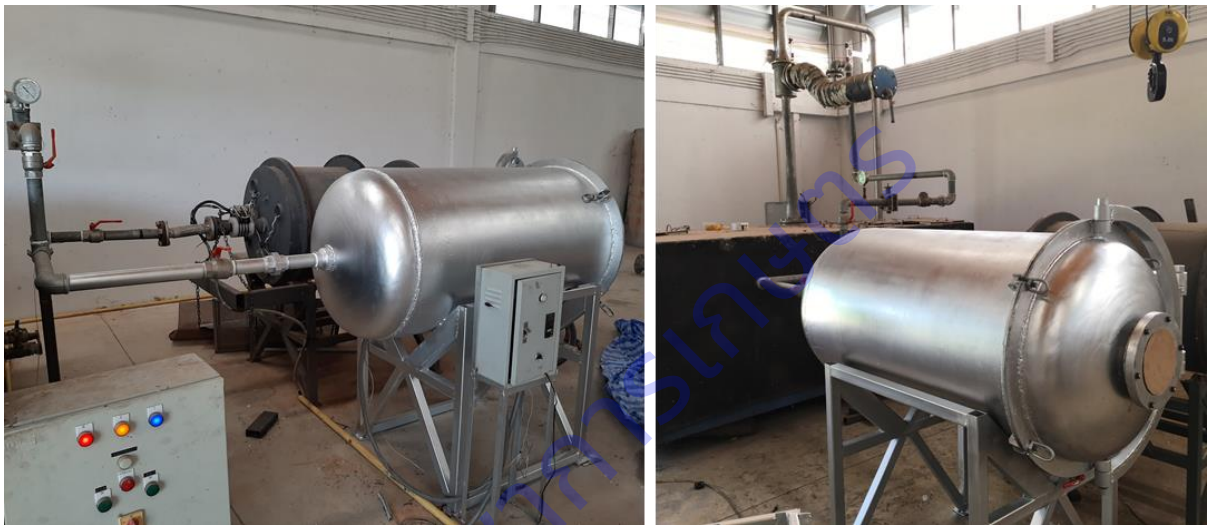
ภาพที่ 1.18 การประกอบถังอบแห้งกับปั๊มสุญญากาศ water jet ที่สร้างเสร็จสมบูรณ์แล้ว
