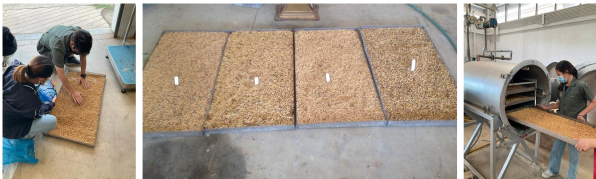
ภาพผนวก ค ที่ 5 การเตรียมเมล็ดพันธุ์ถั่วเหลืองใส่ภาชนะแฉะและนำเข้าเครื่องอบลดแรงดันอากาศ
