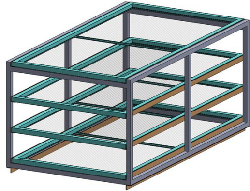
ภาพผนวก ก ที่ 3 แบบชิ้นวางและถาดตะแกรงสำหรับใส่เมล็ดพันธุ์ถั่วเหลืองบรรจุในถังอบแห้งสุญญากาศ
