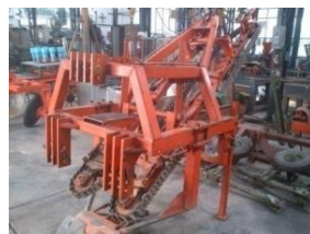
ภาพที่ 30 เครื่องชุดเก็บมันสำปะหลัง ที่มา: ประสาธ และคณะ (2556)
