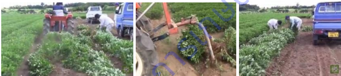
ภาพที่ 8 เครื่องขุดถั่วลิสงขนาดเล็กของประเทศญี่ปุ่น
