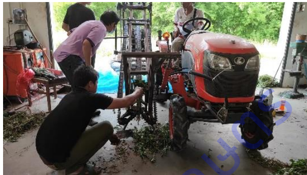
ภาพที่ 54 การทดสอบการปลิดฝักของชุดปลิดในห้องปฏิบัติการ
