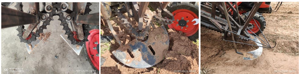
ภาพที่ 53 ผลชุดแบบใบมีด แบบผลคัตทำยแทรกเตอร์ผ่าครึ่งวงกลมแบบไม่เจาะและเจาะช่องคายดินกลางผล
