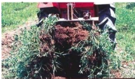
ภาพที่ 15 แสดงลักษณะการทำงานของเครื่องชุดถั่วลิสงเมล็ดโต ที่มา: วินิต (2545)
