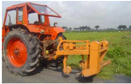
ภาพที่ 7 เครื่องขุดดินถั่วลิสงรุ่น DL -0.3
