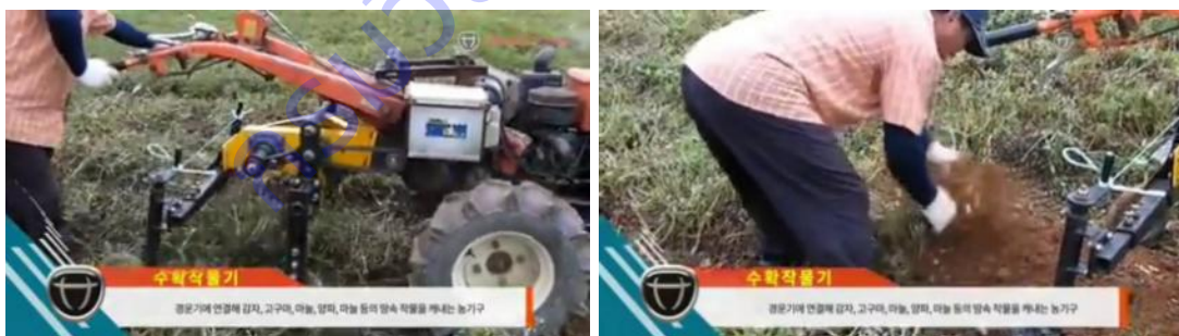
ภาพที่ 9 เครื่องขุดถั่วลิสงขนาดเล็กของประเทศญี่ปุ่น แบบใช้กลไกควบคุมการสั่นที่ขาขุด
