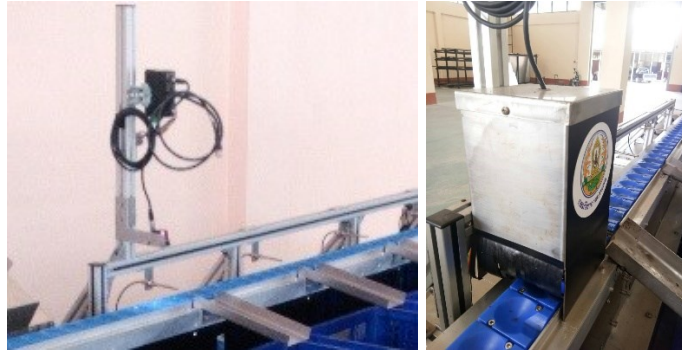
ภาพที่ 21 ติดตั้งห้องครอบตัวกล้องบนสายพานคัดแยก ก่อนปรับปรุง (ซ้าย) หลังปรับปรุง (ขวา)
