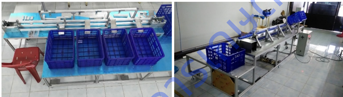
ภาพที่ 17 สร้างต้นแบบเครื่องคัดแยกสีผลสตรอเบอร์รี่โดยใช้เทคนิค Image Processing
