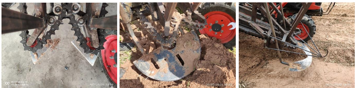
ภาพที่ 20 ผลชุดแบบใบมีด แบบผลคัตทำยแทรกเตอร์ผ่าครึ่งวงกลมแบบไม่เจาะและเจาะช่องคายดินกลางผล
