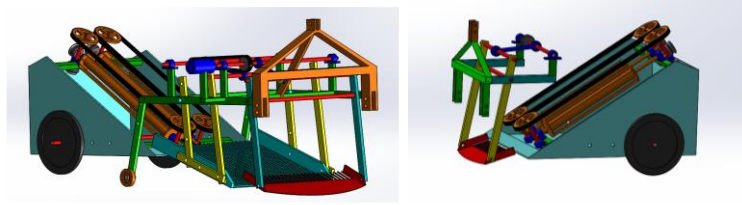
ภาพที่ 11 แบบเครื่องชุดและปลิดฝักถั่วลิสง (ก) มีตะแกรงร่อนเศษดิน และ (ข) ไม่มีตะแกรงร่อนเศษดิน
