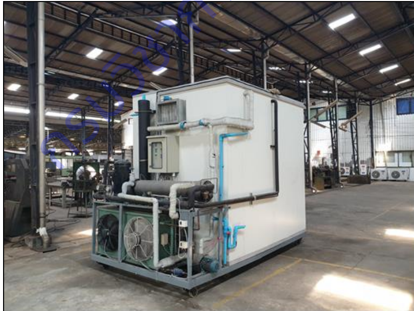
ภาพผนวกที่ 6 ต้นแบบเครื่องลดความชื้นแบบปั๊มความร้อน (ด้านหลัง)
