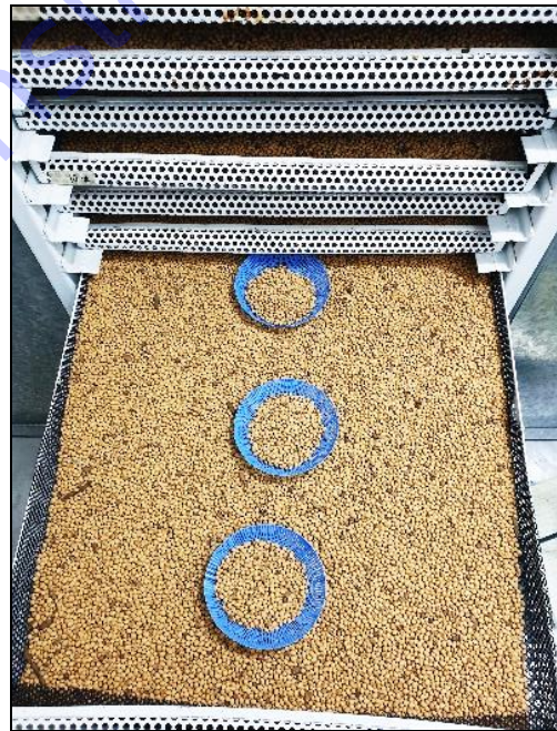
ภาพผนวกที่ 2 ตำแหน่งตัวอย่างเมล็ดพันธุ์ถั่วเหลืองสำหรับการตรวจสอบความชื้น ในเครื่องอบลดความชื้นแบบ ปั๊มความร้อน ณ สถาบันวิจัยเกษตรวิศวกรรม กรมวิชาการเกษตร กรุงเทพฯ
