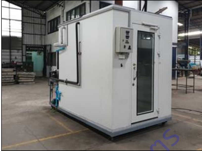
ภาพผนวกที่ 5 ต้นแบบเครื่องลดความชื้นแบบปั๊มความร้อน (ด้านหน้า)
