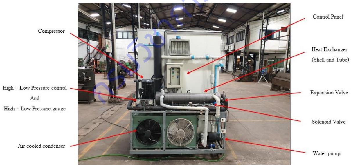
ภาพที่ 25 ระบบปั๊มความร้อนแบบ Hydro Heat pump
