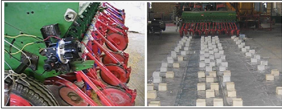
ภาพที่ 9 เครื่องหยอดเมล็ดพันธุ์พืชที่ปรับอัตราการหยอดด้วยมอเตอร์ไฟฟ้า ที่มา: M. Jafari et al. (2010)
