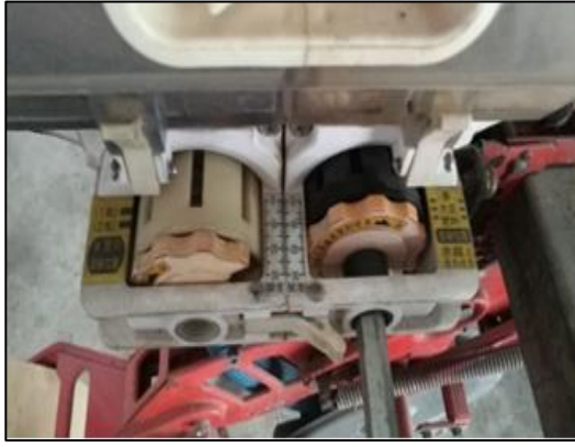
ภาพที่ 5 สกรูปรับขนาดล้อรองของรูลอยดเมล็ด (ซ้าย) และสกรูปรับขนาดล้อรองของรูลอยดปุ๋ย (ขวา)
