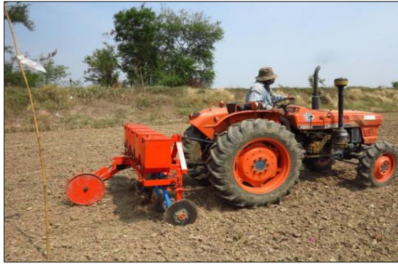
ภาพที่ 7 เครื่องหยอดพืชหลังนาติดพวงท้ายรถแทรกเตอร์ ที่มา: ยุทธนาและคณะ (2556ข)
