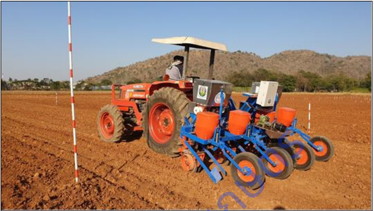
ภาพที่ 23 เครื่องหยอดเมล็ดพืชและปุ๋ยแบบอัตโนมัติที่ควบคุมอัตราการหยอดด้วยสมองกลฝังตัว
