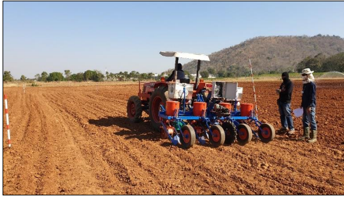
ภาพที่ 17 การทดสอบอัตราการหยอดเมล็ดพืชในภาคสนาม
