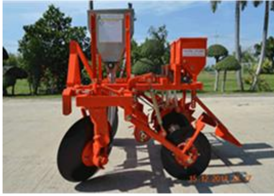
ภาพที่ 3 เครื่องหยอดเมล็ด ถั่วลิสง พร้อมใส่ปุ๋ย แบบยกร่อง ที่มา: พรเจริญ (2561ข)
