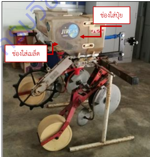
ภาพที่ 3 เครื่องหยอดเมล็ดพร้อมหยอดปุ๋ยฟางทำยรถแทรกเตอร์ขนาดเล็กของประเทศญี่ปุ่น
