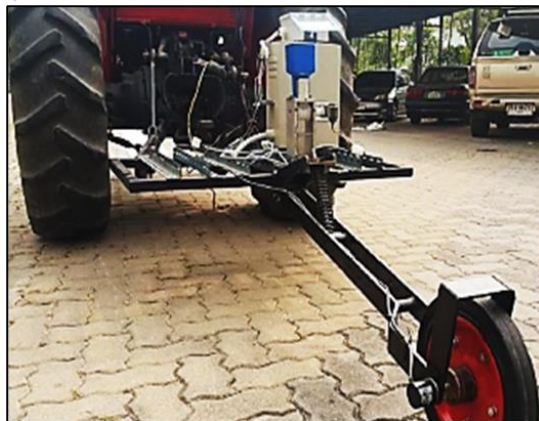
ภาพที่ 7 ระบบหยอดสารเคมีเพื่อกำจัดศัตรูพืชควบคุมด้วยไมโครคอนโทรลเลอร์ ที่มา: สายรุ่งและวสุ (2558)
