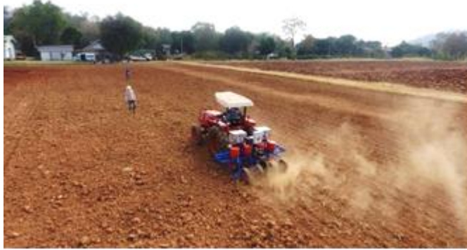
ภาพที่ 21 การทดสอบเครื่องหยอดเมล็ดพืชและปุ๋ยแบบอัตโนมัติในแปลงทดสอบ
