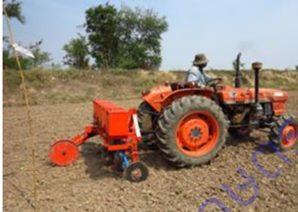
ภาพที่ 6 เครื่องหยอดพืชหลังนาติดพวงท้ายรถแทรกเตอร์ ที่มา: ยุทธนาและคณะ (2556ข)
