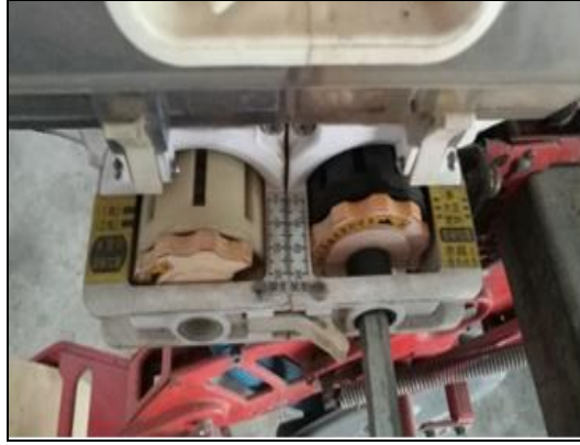
ภาพที่ 4 สกรูปรับขนาดล้อรองของรุธยอดเมล็ด (ข้าว) และสกรูปรับขนาดล้อรองของรุธยอดปุ๋ย (ข้าว)
