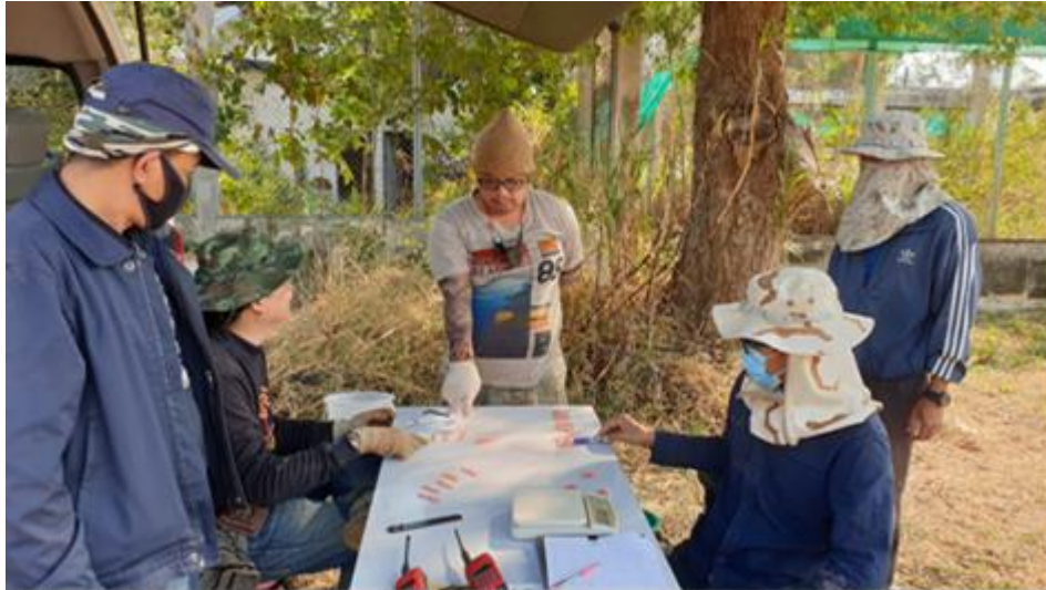
ภาพที่ 18 การวัดและชั่งน้ำหนักเมล็ดเพื่อหาอัตราการหยอดเมล็ดพืชในภาคสนาม
