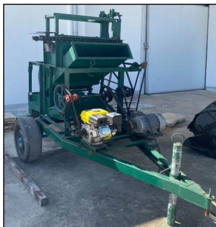
ภาพที่ 1 ต้นแบบเครื่องปดฝักถั่วลิสงระบบป้อนอัตโนมัติ
