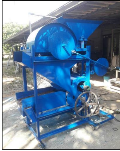
ภาพที่ 2 ต้นแบบของเครื่องกะเทาะถั่วลิสงแบบล้ออย่างที่ใช้การกะเทาะแบบหมุนไป-กลับ
