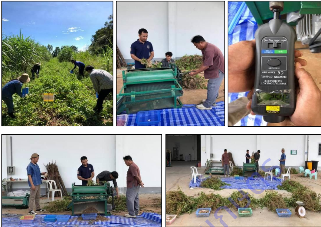
ภาพที่ 18 เก็บเกี่ยวหัวปลีขนาดเล็ก และทดสอบการปลิดฝักหัวปลีด้วยเครื่องปลิดฝักตามความเร็วรอบที่กำหนดเพื่อหาความเร็วรอบที่เหมาะสม
