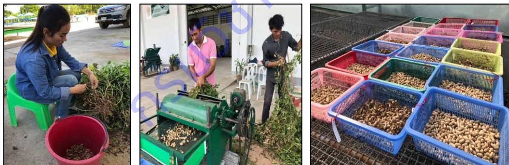
ภาพที่ 19 การปลิดฝักสดด้วยแรงงานคนและกรรมวิธีปลิดฝักสดด้วยเครื่องปลิดฝักสดหัวปลีในระดั การตั้งค่าเครื่องระดับ 1 2 และ 3 และการปรับปรุงสภาพเมล็ดโดยการลดความชื้นเพื่อเตรียม ตัวอย่างส่งตรวจวิเคราะห์คุณภาพเมล็ดพันธุ์
