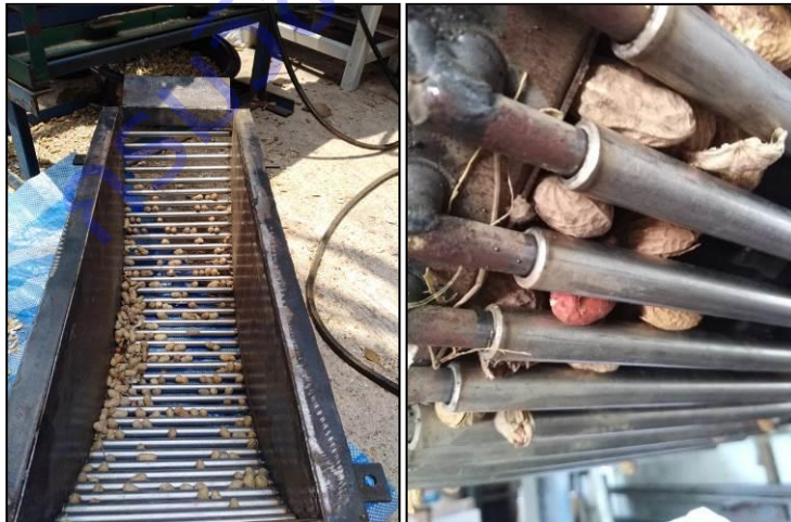
ภาพที่ 22 ตะแกรงที่จะใช้ในการทดสอบแบบใหม่มีกระบอกหมุน
