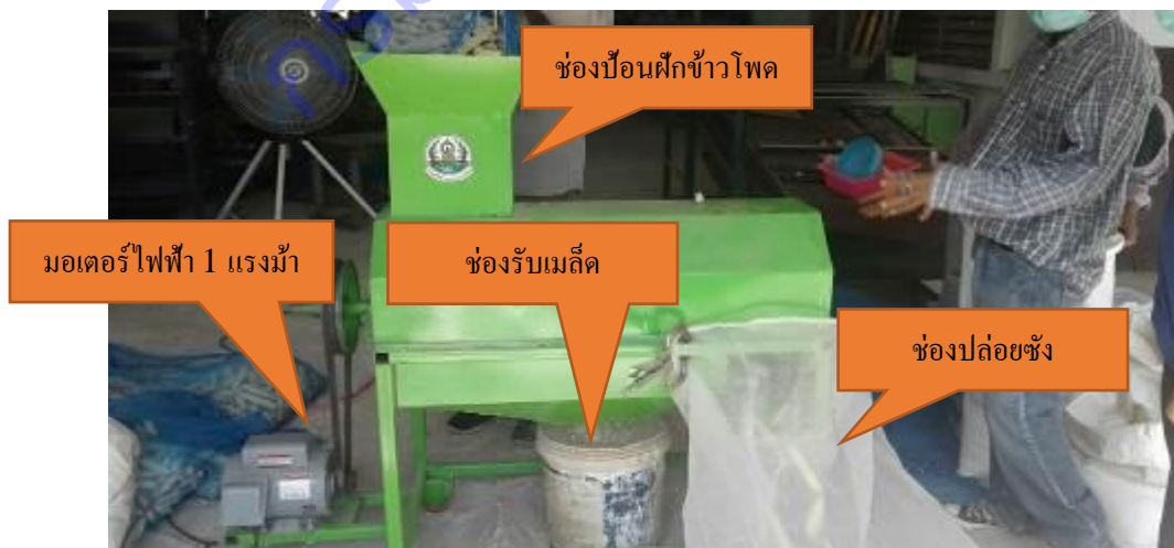
รูปที่ 3 ต้นแบบเครื่องกะเทาะเมล็ดพันธุ์ข้าวโพดขนาดเล็ก
