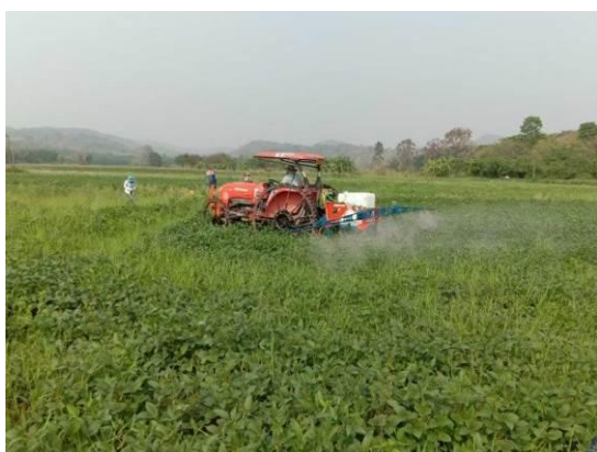
การฉีดพ่นสารเคมีป้องกันกำจัดแมลง ด้วยรถแทรกเตอร์ติดอุปกรณ์แขนฉีดยาวกว้าง 8 เมตร ระยะครอบคลุม 10 เมตรด้วย Kubota L4708 ล้อยกสูง ความเร็ว L4 รอบเครื่อง 1300-1400 RPM, PTO 540 แรงดันปั๊มฉีด 5 bar เปิดหัวฉีดทุกหัว
