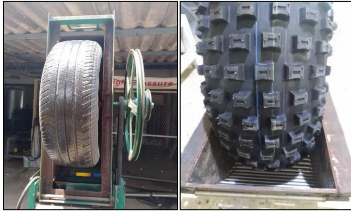
ภาพที่ 23 ลักษณะล้อที่จะใช้ในการทดสอบ(ซ้าย)แบบเดิม (ขวา) แบบที่ทำการปรับปรุง
