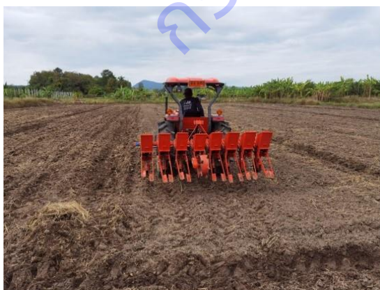
การปลูกโดยใช้แทรกเตอร์ Kubota รุ่น L5018 เกียร์ low4 ต่อพ่วง ด้วยเครื่องหยอดเมล็ด MS 360 จำนวน 8 ลูก หยอด ระยะหยอด 30 cm ปลูกทั้งแปลง ระยะปลูก 30 ซม. x 20 ซม.
