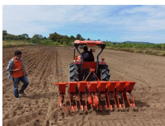
การปลูกโดยใช้แทรกเตอร์ Kubota รุ่น L5018 เกียร์ low4 ต่อพ่วง ด้วยเครื่องหยอดเมล็ด MS 360 จำนวน 8 ลูก หยอด ระยะหยอด 30 cm ปลูกทั้งแปลง ระยะปลูก 30 ซม. x 20 ซม.
