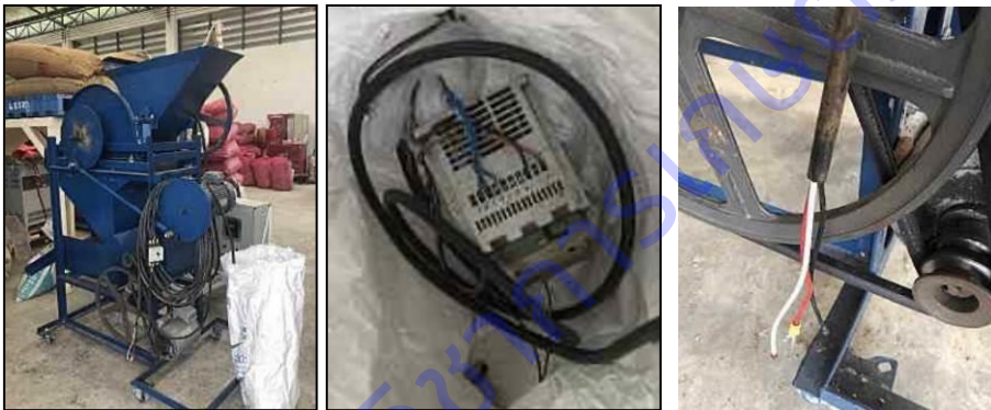
ภาพที่ 42 ระบบไฟฟ้าของเครื่องกะเทาะฝักถั่วลิสงพร้อมระบบทำความสะอาดชำรุดไม่สามารถใช้งานได้
