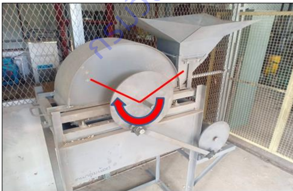
ภาพที่ 26 ลักษณะการหมุนปรับองศาการหมุนของล้อย่างจาก 360 องศาเป็น 240 องศา
