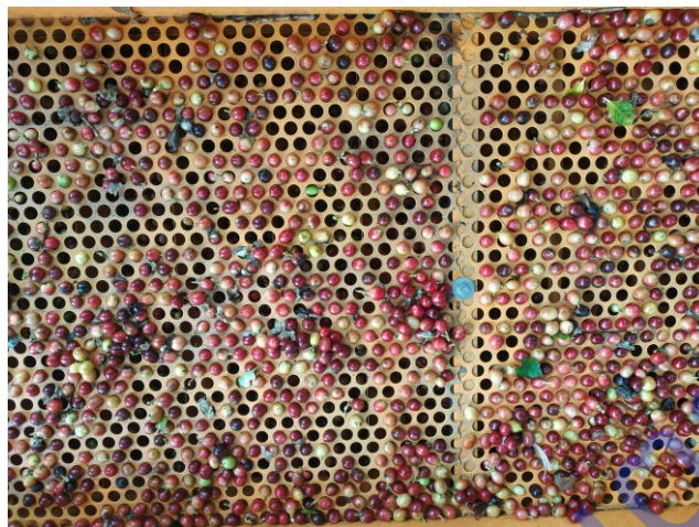
ภาพที่ 1.4 ผลการทดสอบตะแกรงรูลขนาด 10 มิลลิเมตร
