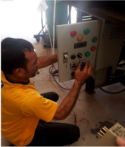
ภาพที่ 3.3 ทำการปรับปรุงเครื่องอบโรตารีเดิมเพื่อใช้ทดสอบอบกาแฟ
