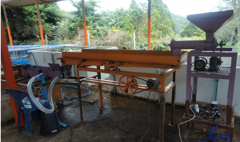
ภาพที่ 1.9 แสดงเครื่องล้างทำความสะอาดผลกาแพะราบิกา
