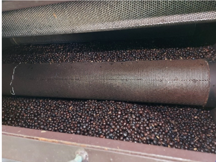
ภาพที่ 3.16 เมล็ดกาแฟยุบตัวลง จนระดับเมล็ดกาแฟต่ำกว่าท่อลมออก
