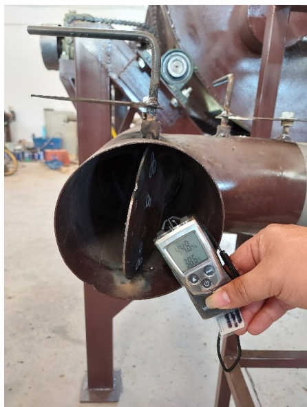
ภาพที่ 3.15 วัดค่าอุณหภูมิ ความชื้น และความเร็วลมที่ท่อออก
